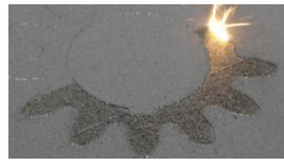
Obr. 6 Přímé laserové spékání [10]
