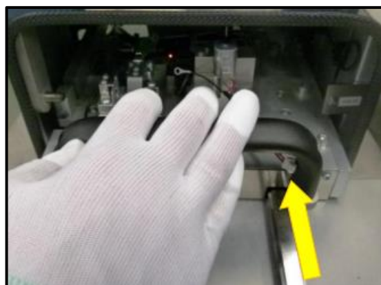
Obrázek 13: Zasouvání do lisu (Zdroj: Interní materiály podniku)
