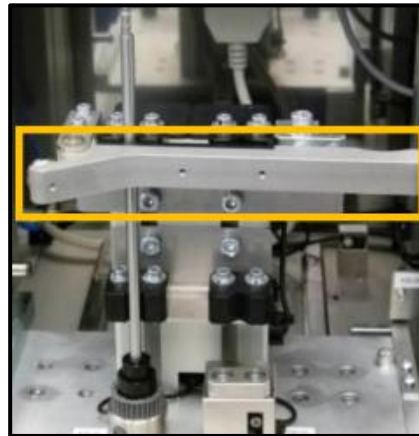
Obrázek 14: Založení hřídele do přípravku (Zdroj: Interní materiály podniku)
