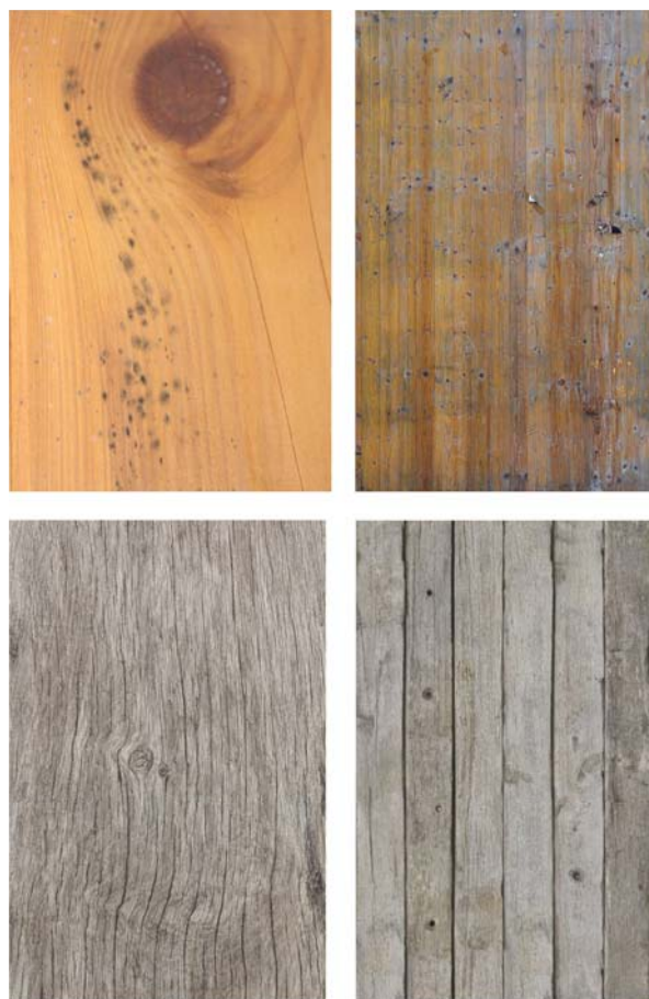
Obr. 140. Lakovaný obklad a obklad bez akéhokoľvek náteru po niekoľkých rokoch. (foto: Milan Šuška)
