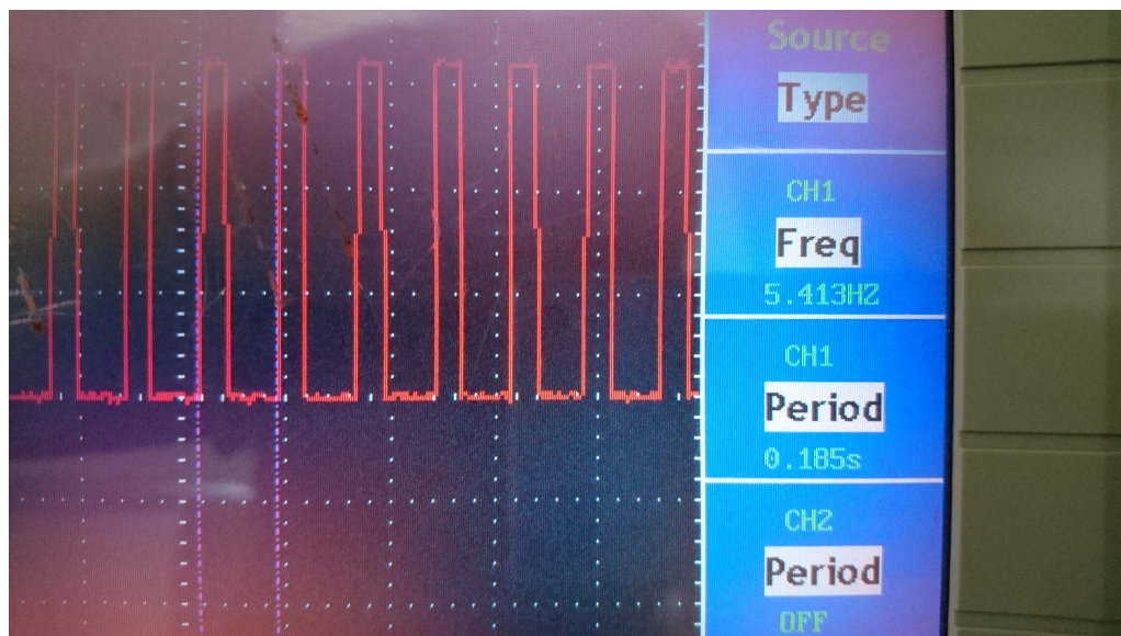
Obrázek 5.5: Fotka osciloskopu ukazující frekvenci mikrokontroléru.
