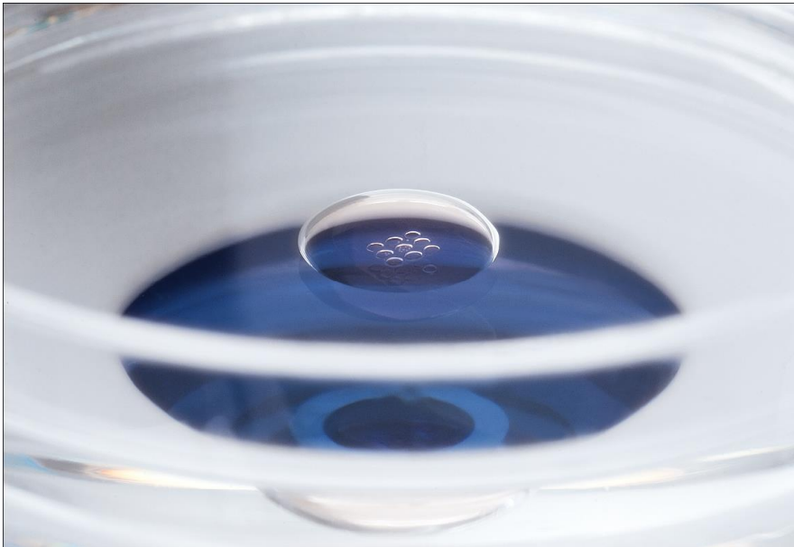
Obrázek 12 Speciální kultivační miska pro time-lapse systém Primo Vision
