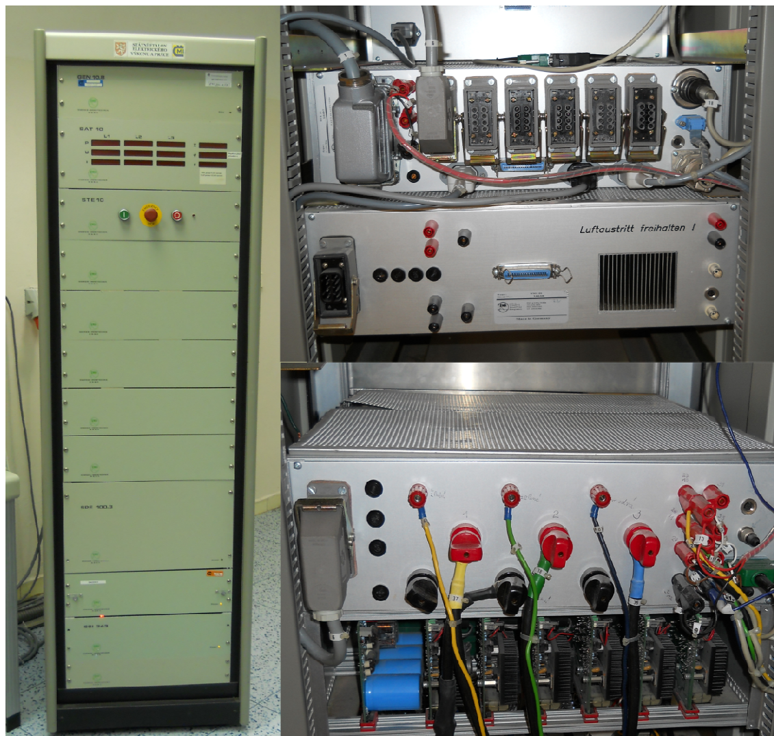
Obr.28 Výkonový zdroj s etalonovým elektroměrem EMH ENZ 200.3
