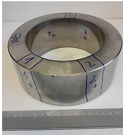
Obr. 102 Vzorek s označením WC s vrstvou nástřiku WC s vyznačenými místy řezu na metalografii
