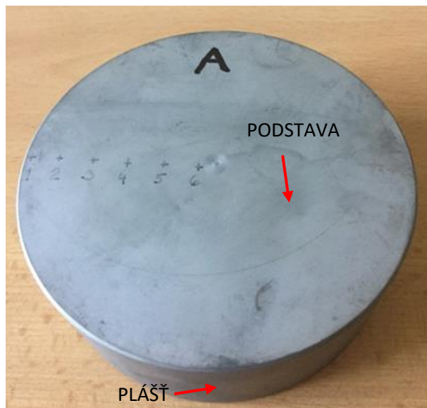
Obr. 52 Vzorek a výbrus s označnými směry zatěžování
