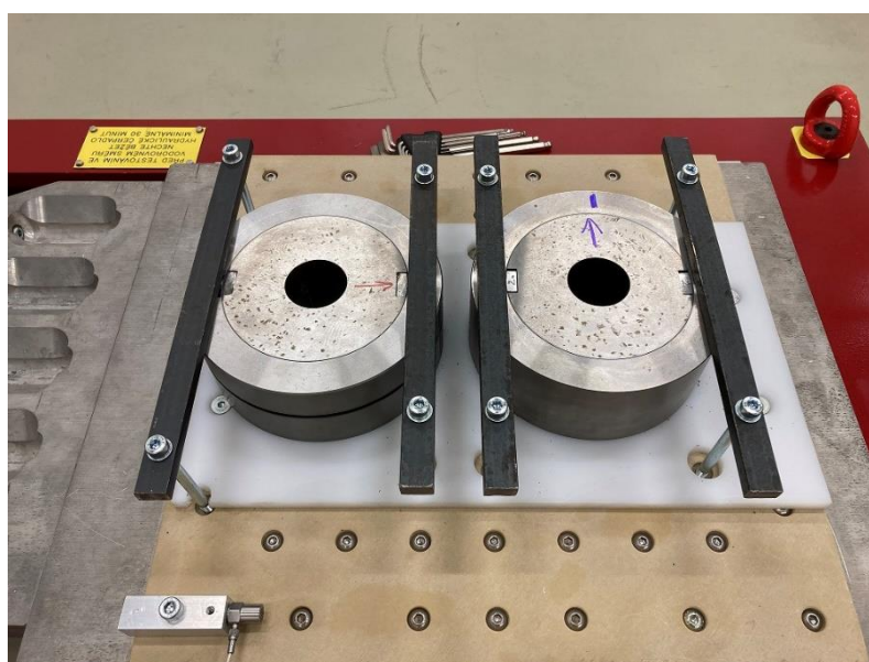
Obr. 175 Zobrazení horizontálního uložení vzorků na budiči vibrací
