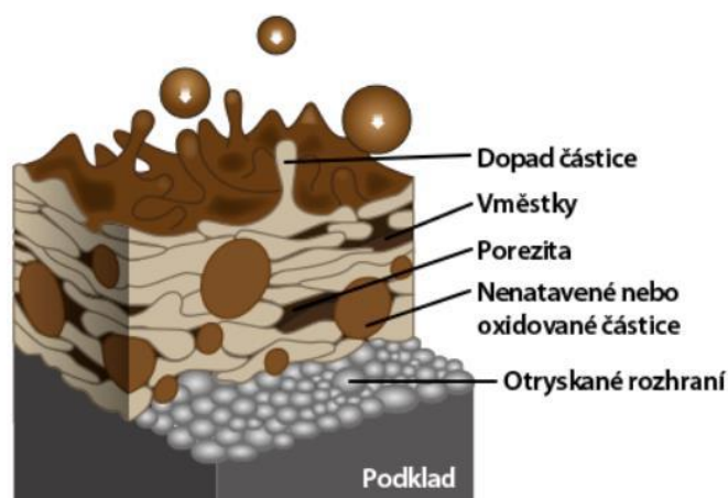
Schéma řezu žárově nastříkané vrstvy
