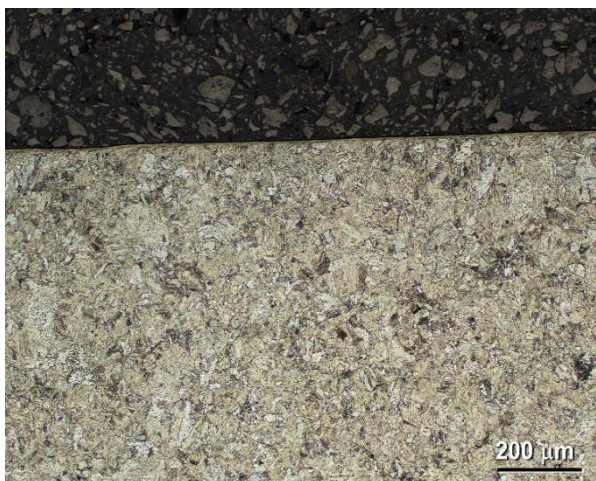
Obr. 152 Vzorek Ferro, vnější část prstence bez vrstvy, kraj-100x-SM
