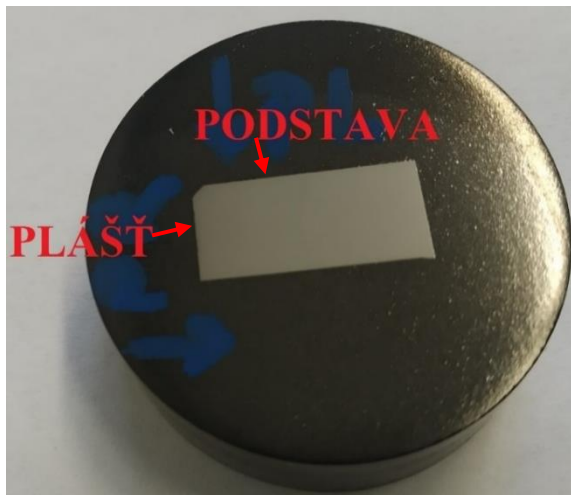
Obr. 52 Vzorek a výbrus s označnými směry zatěžování
