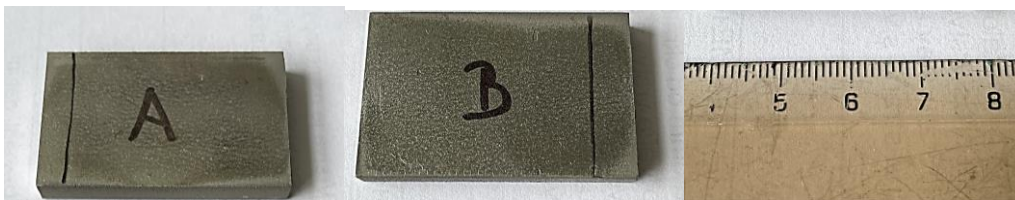
Obr. 77 Vzorky s vrstvami nástřiku NiCrBSi s označením A, B s vyznačeným místem řezu pro odběr metalografických vzorků
