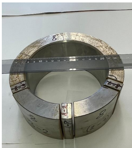
Obr. 151 Vzorek Ferro s vrstvou nástřiku Ferro 55 (FeCrMo) s vyznačenými místy řezu na metalografii
