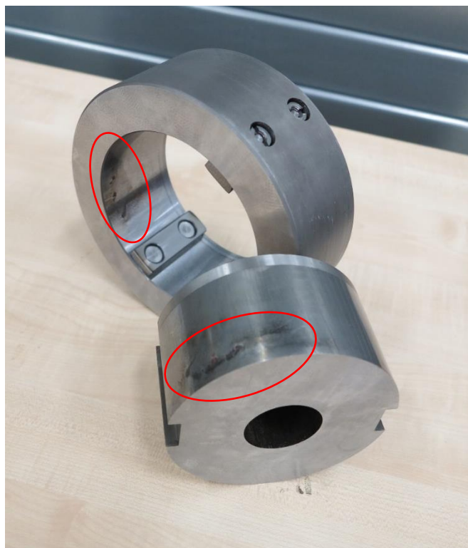
Obr. 178 Původní vzorek po zkouškách na budiči vibrací - vznik vibrační koroze na dutém i pracovním vřetenu
