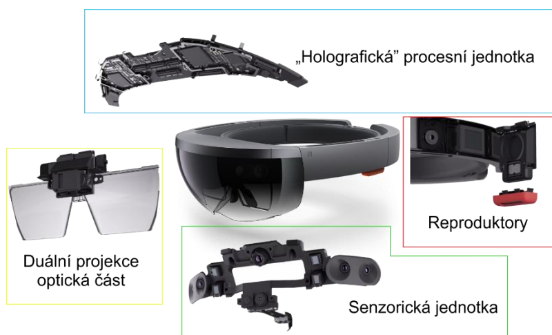
Obrázek 7 - Microsoft HoloLens – základní komponenty 76
