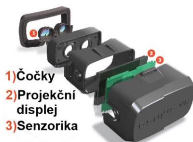
Obrázek 9 - Řez zařízením Oculus Rift 88
