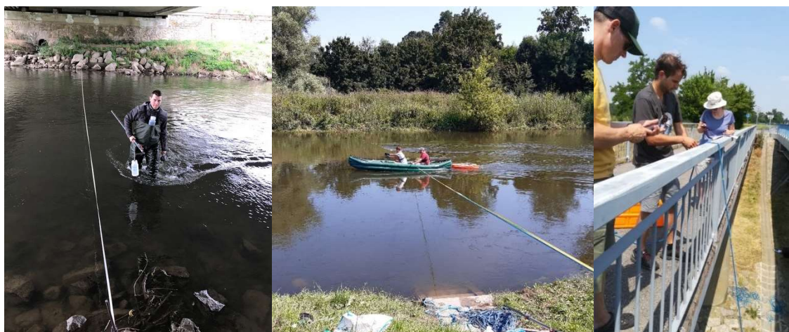
Obr. 11. Měření distribuce koncentrace suspendovaných látek v příčném profilu broděním (vlevo), ze člunu (uprostřed) a z mostu (vpravo) [3], [5]
