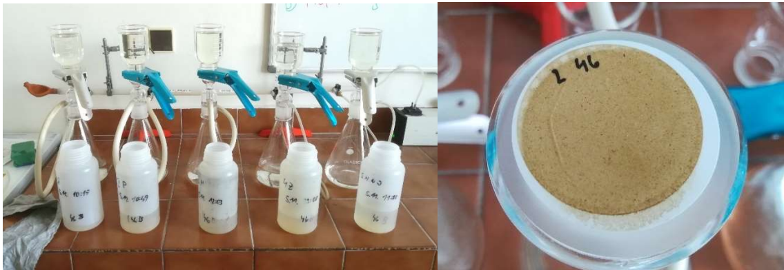
Obr. 26. Měření nerozpuštěných látek v mg/l pomocí membránové vývěvy přes filtrační soupravu v laboratoři na Ústavu vodního hospodářství krajiny (vlevo) a nerozpuštěné látky z Příbic (odběr dne 05.11.2021) zachycené na membránovém filtru (vpravo) [10]
