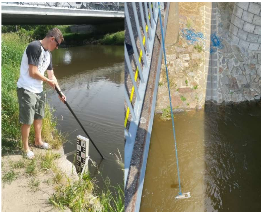
Obr. 5. Možné vzorkovací zařízení: vzorkovač na tyči (vlevo) a sběrač zavěšený na laně (vpravo) [5]
