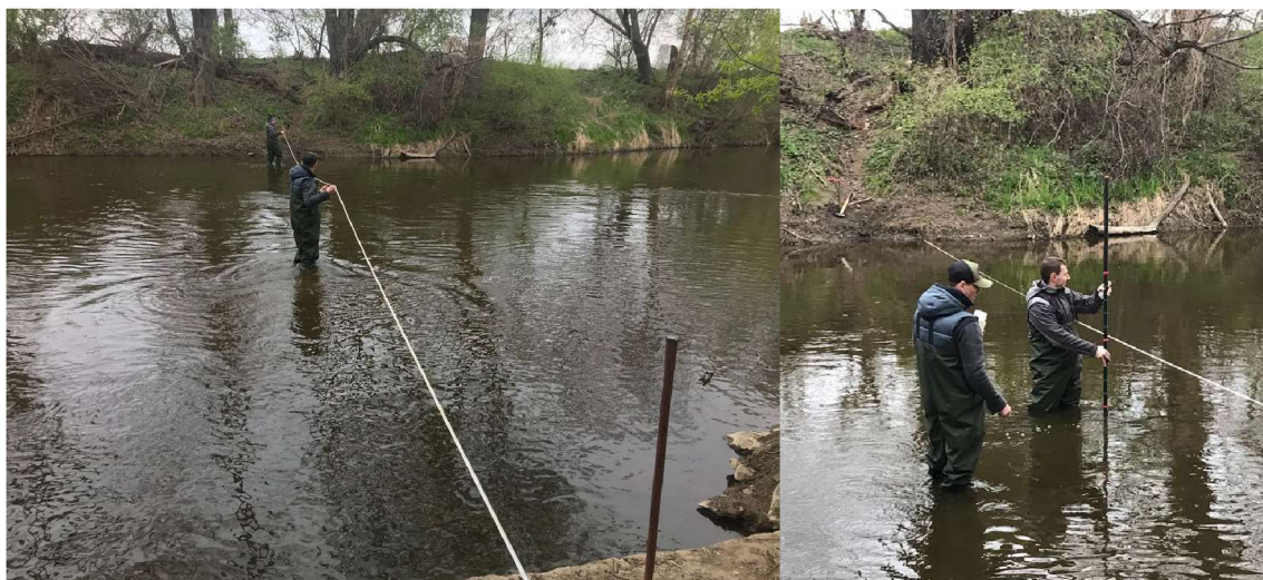
Obr. 24. Natažení měrného pásma (vlevo) a provádění odběrů vícebodovou metodou (vpravo)
