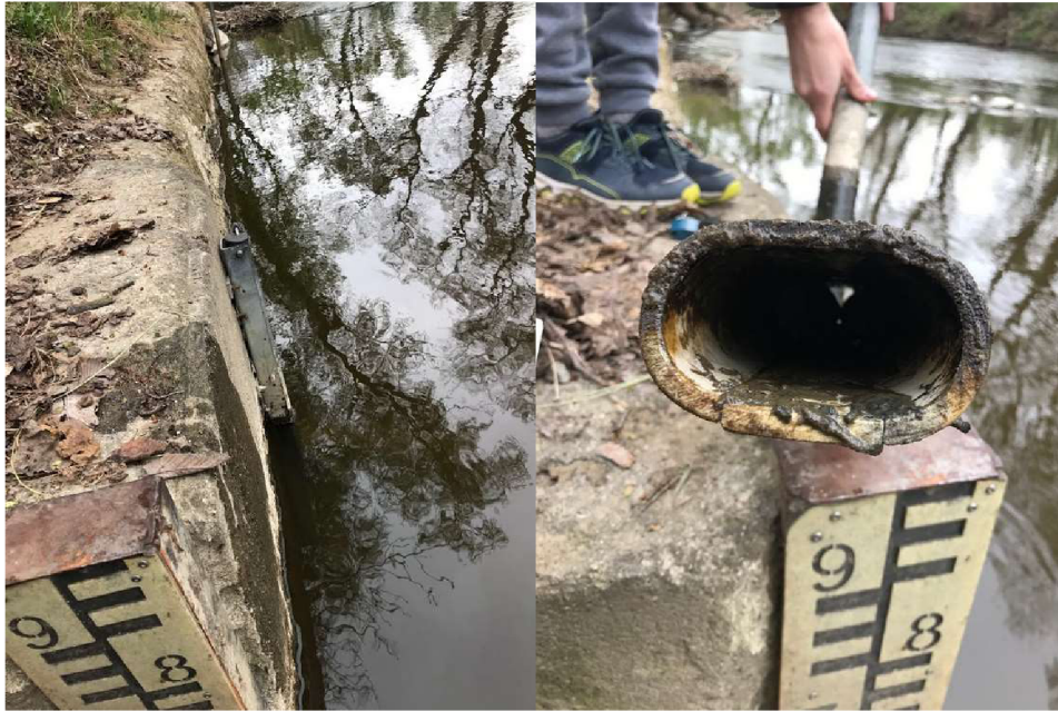
Obr. 20. Umístění sondy v Přibicích (vlevo), znečištění sondy v Přibicích (vpravo)
