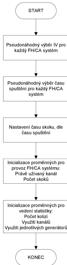
Obr. B.7: Vývojový diagram simulátoru, část fhsim_fhca_create.
