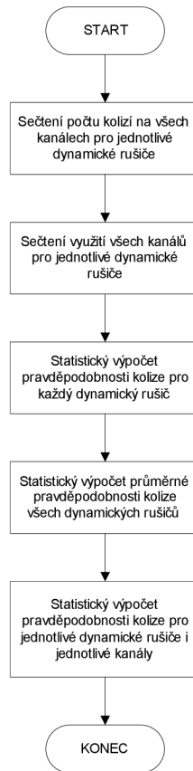
Obr. B.19: Vývojový diagram simulátoru, část fhsim_dj_collision_calc_afterstim.
