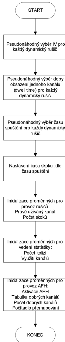
Obr. B.6: Vývojový diagram simulátoru, část fhsim_dj_create.
