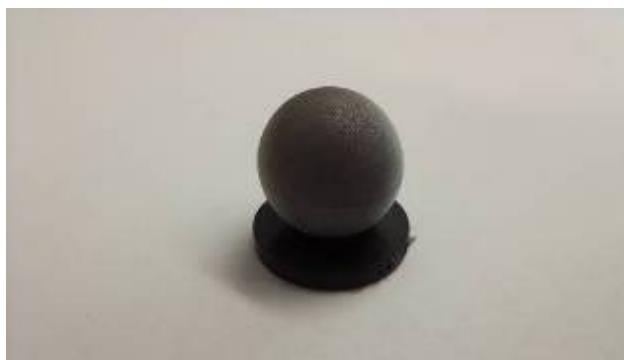
Obrázek 2.4. Kamery snímají markery - reflexní kulička
