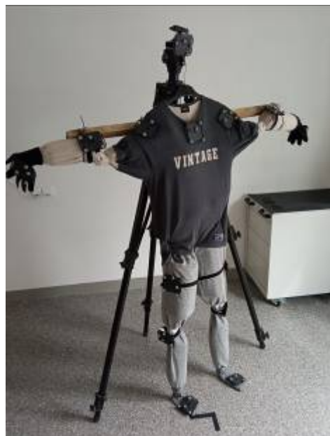
Obrázek 2.6. Využití rigid bodů a markerů pro snímání postavy
