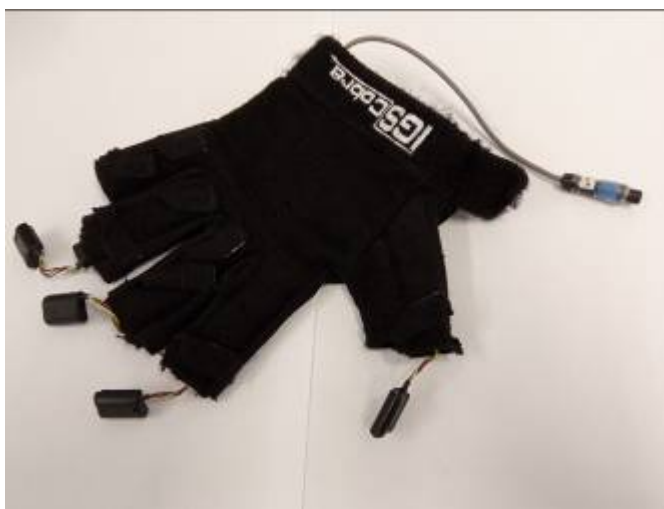
Obrázek 2.9. Speciální rukavice pro snímání pohybu prstů
