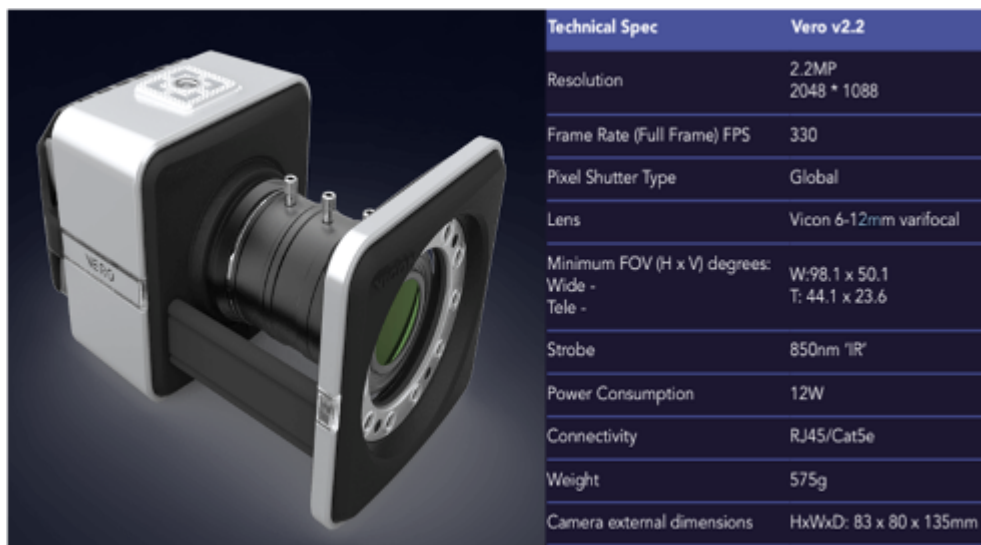
Obrázek 2.16. Kamera Vicon Vero v2.2.
