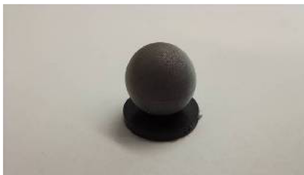
Obrázek 2.4. Kamery snímají markery - reflexní kulička
