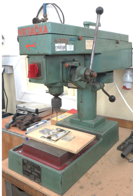
Obr. 35 Vrtačka V10 s upnutým vrtákem 4,1 mm a přípravkem pro svrtání plechů [autor]
