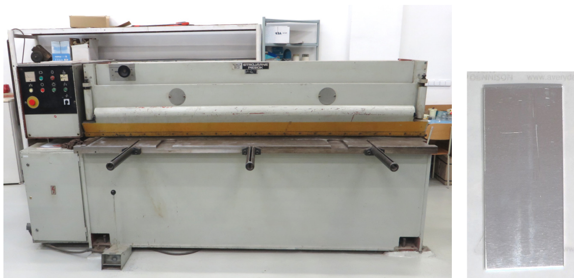
Obr. 34 Padací nůžky NTC 2500/4 a polotovary po dělení stříhem [autor]
