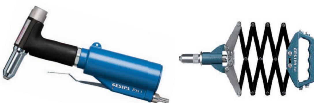
Obr. 14 Pneumaticko-hydraulická pistole a ruční nůžkové kleště [16]
