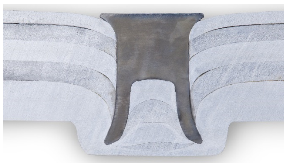
Obr. 26 Řez nýtovým spojem vytvořeným nýtem SPR [49]
