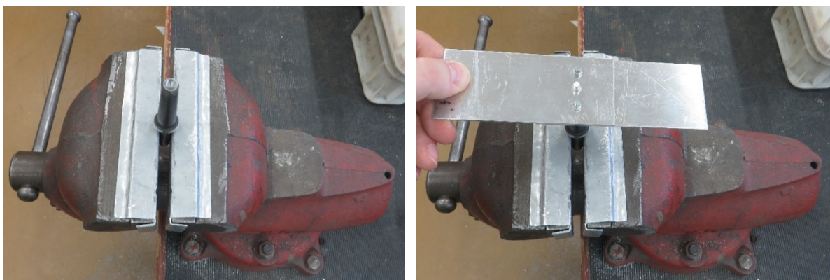
Obr. 39 Průběh nýtování duralových plných nýtů [autor]
