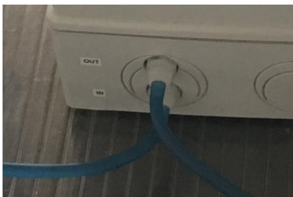
Obrázek č. 4: Zapojení hadiček pro čerpání vody ze zásobní nádrže k čerpadlu a trysce simulátoru
