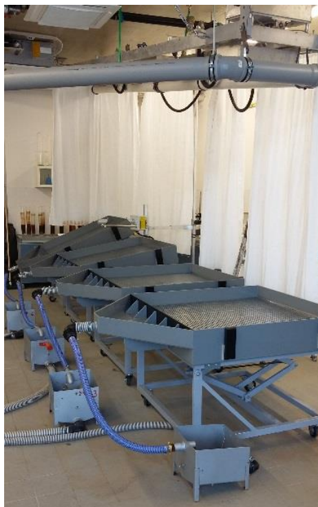
Obrázek č. 10: Pokusné odtokové žlaby s překlápěcími průtokoměry
