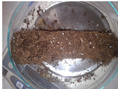
Obr. 9: Vážení kořenového balu v laboratoři po exponování při 20 °C, autorka Lázničková, 2015
