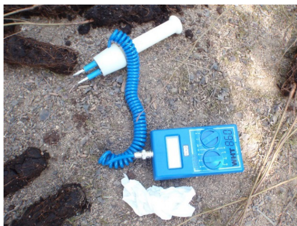
Obr. 4: Měření vlhkosti kořenových balů pomocí přístroje WHT 860, autorka Houšková, 2015
