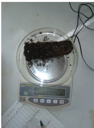
Obr. 3: Měření hmotnostního úbytku balů v laboratoři, autorka Lázničková, 2015
