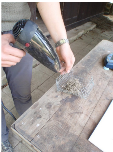
Obr. 2: Působení konstantního tepelného stresu fénováním na vzorek jemných kořenů, autorka Houšková, 2015
