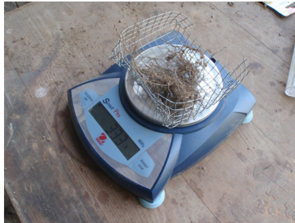
Obr. 1: Měření hmotnostního vzorku jemných kořenů pomocí přesné váhy, autorka Houšková, 2015
