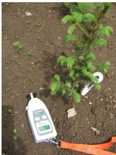
Obr. 6: Sazenice smrku připravená k odečtu maximálního kvantového výtěžku (QY), fluorpen FP 100, klip pro zatemnění, autorka Lázničková, 2015
