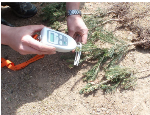
Obr. 5: Měření fluorescence chlorofylu přístrojem Fluorpen FP 100 pro hodnocení celkové fyziologické kvality sadebního materiálu, autorka Houšková, 2015
