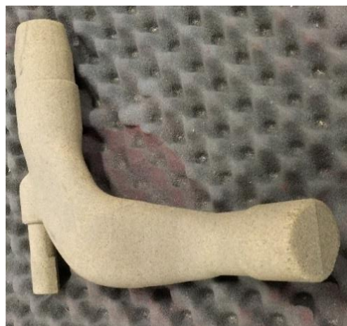
Obr. 16 Pískové jádro odlitku K-251
