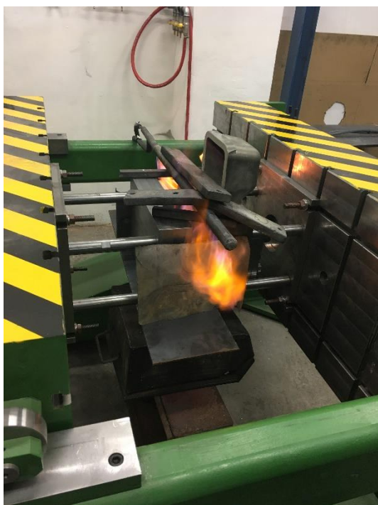
Obr. 29 Předehřev formy K-252
