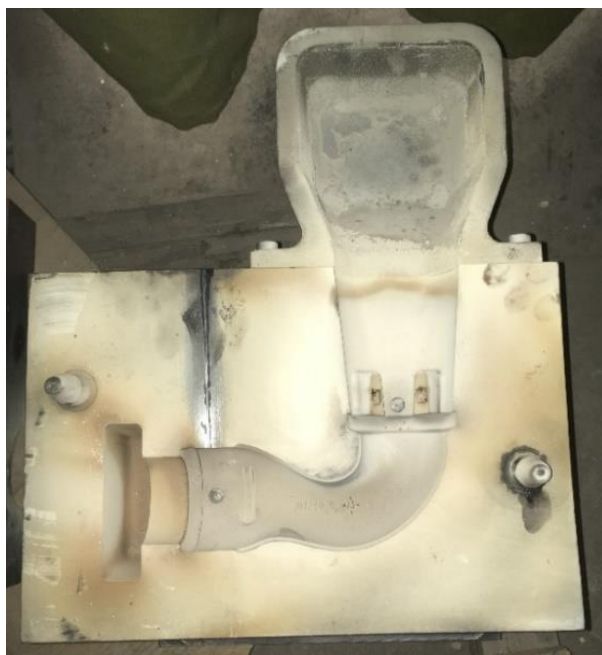
Obr. 21 Výfukový kanál na spodní polovině kokily
