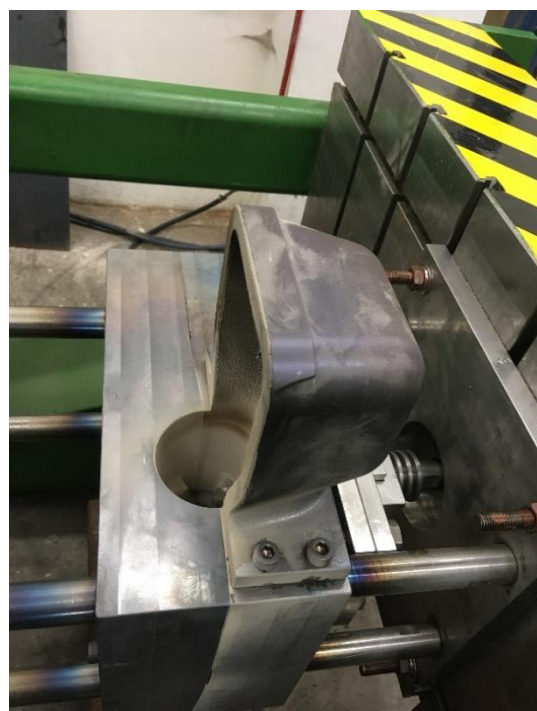
Obr. 30 Předehřátá sevřená forma K-252
