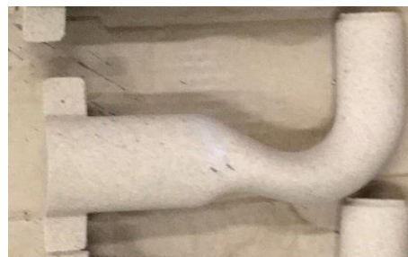
Obr. 13 Pískové jádro odlitku K-252
