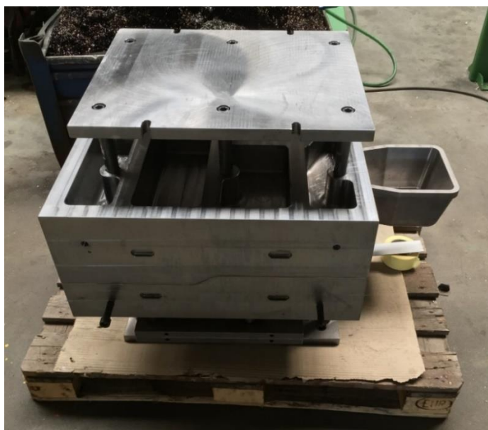
Obr. 9 Kokila pro sklopné lití o hmotnosti 1,2 tuny
