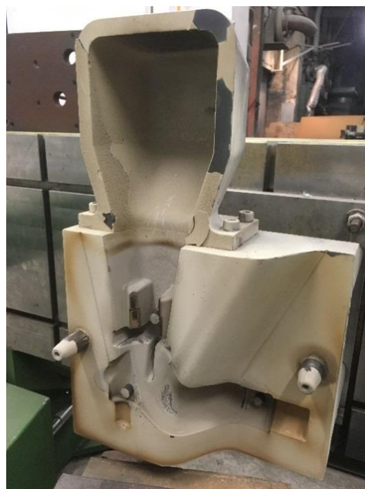
Obr. 28 Vybroušené výfukové kanály v dělicí rovině kokily K-251
