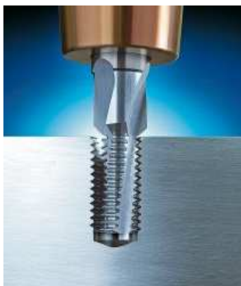
Obr. 2.3 Výroba vnitřních závitů do ocelí s vysokou pevností (60 HRC) (6)
