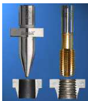
Obr. 2.6 Výroba závitů pomocí hrotu a tvářecího závitníku (5)
