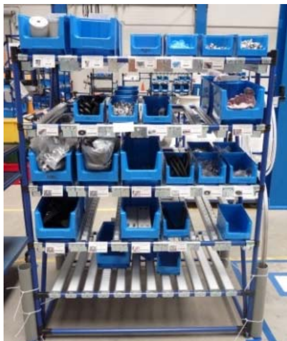
Obr. 3.7 Umístění materiálu na válečkových drahách dle principů FIFO
