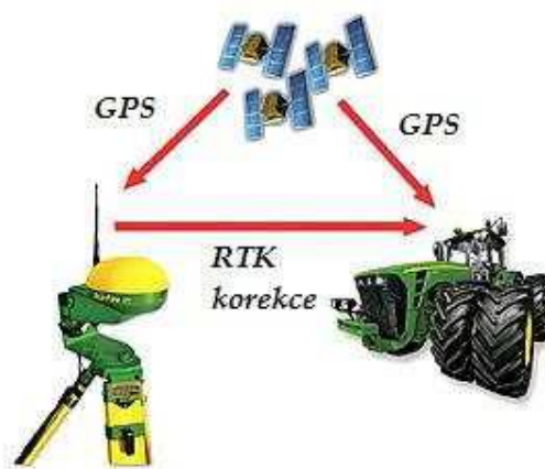
Obr. 6 - Schéma RTK korekce (Fasora, 2012)
