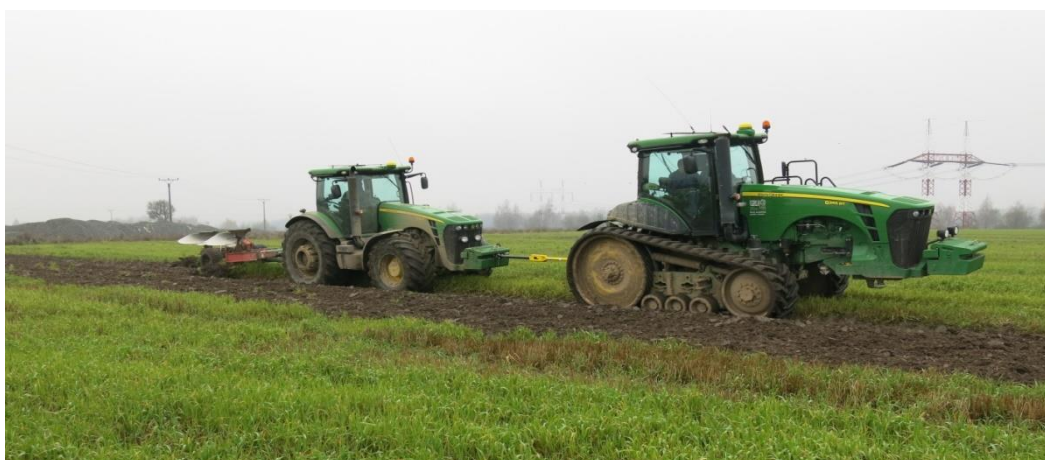
Obr. 28 - Měřicí souprava při měření tahové síly
