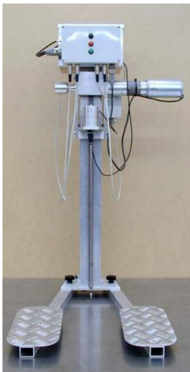
Obr. 17 - Poloautomatický penetrometr (Yurui, a další, 2008)
