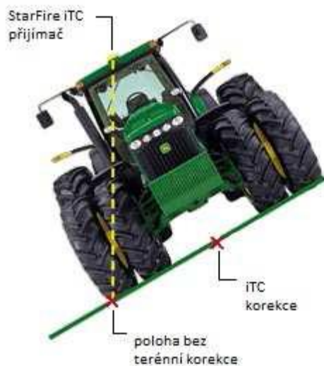
Obr. 8 - Princip terénního vyrovnání (Fasora, 2012)
