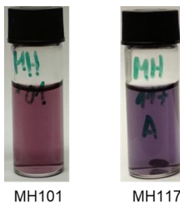
Obrázek 19 – Vzorčky připravené stejným postupem MH101 neagregované AuNPs, MH117 agregované AuNPs.
