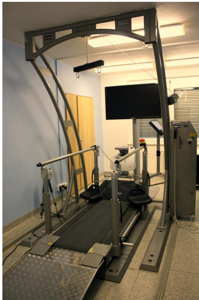
Příloha 2 Chodící pás Zebris FDM-T se zabudovanou silovou plošinou (vlastní fotografie)
