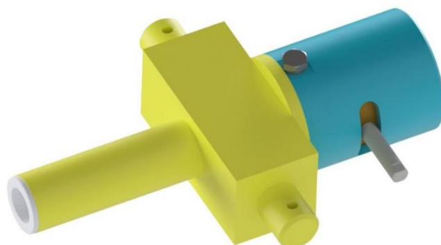
Obr. 13 – Automatický kompenzátor opotřebení brzdového obložení
