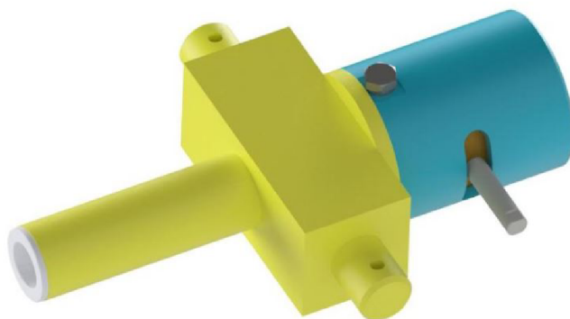
Obr. 13 – Automatický kompenzátor opotřebení brzdového obložení
