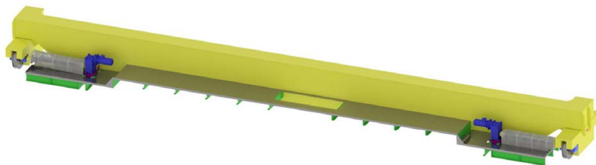
Obr. P1 – Umístění dislokovaných mechanismů na lávce hlavního nosníku
