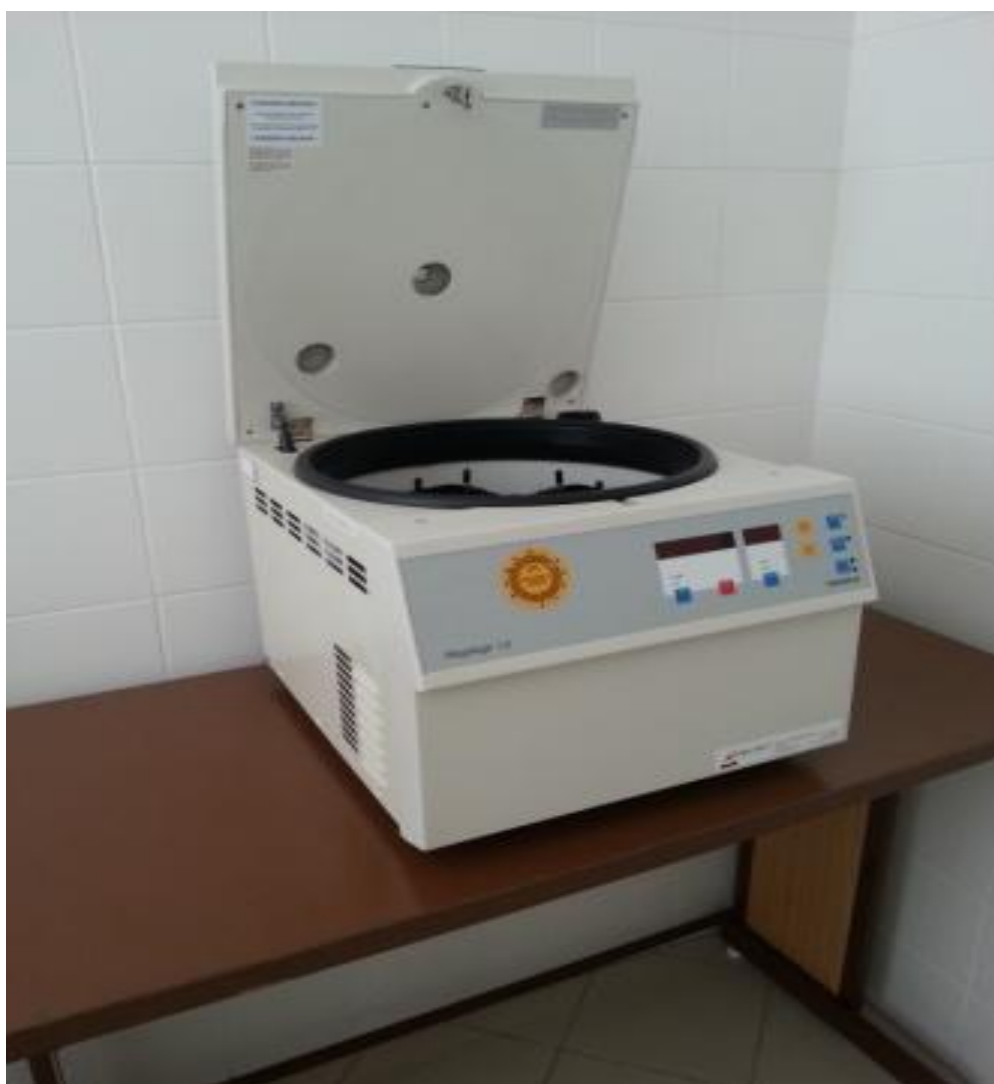
Obr 4: Centrifuga Megafuge 1.0 ( Zdroj: vlastní foto )
