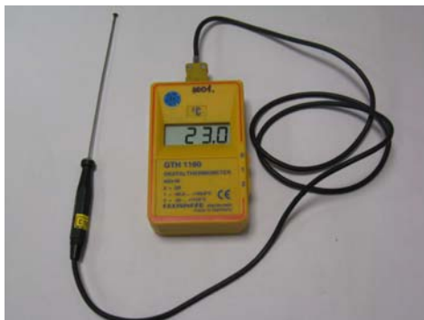
Obr.6.4 Propojení senzoru s multimetrem. Zdroj: [ 6]
