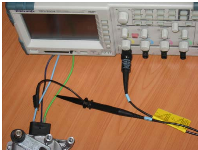
Obr.4.13 Napěťová sonda zapojena při měření na stejnosměrném motoru. Zdroj: [6]
