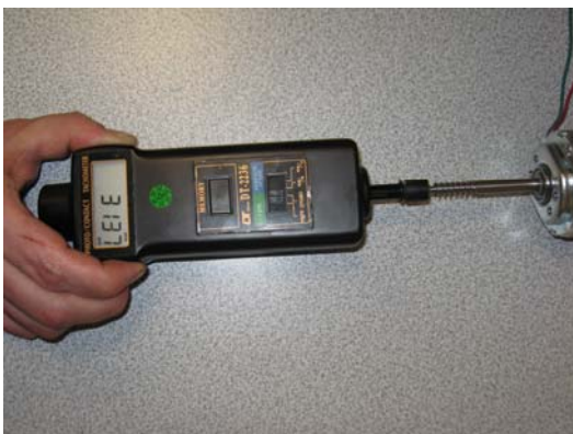
Obr.5.2 Metoda kontaktního měření otáček digitálním otáčkoměrem. Zdroj: [6]
