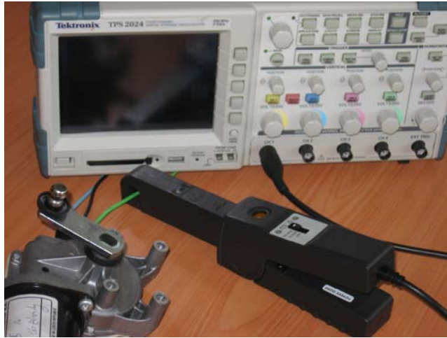
Obr.4.12 Proudová sonda zapojena při měření stejnosměrného motoru. Zdroj: [6]
