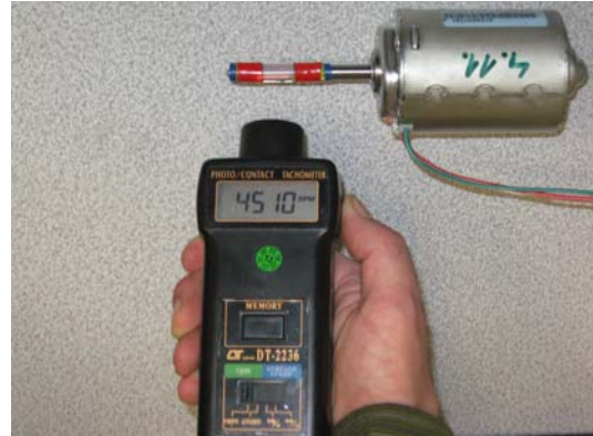
Obr.5.3 Metoda bezkontaktního měření otáček digitálním otáčkoměrem. Zdroj: [6]
