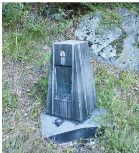
Obr. č. 11 Ukázka stabilizace nivelačního bodu – pomník [3]
