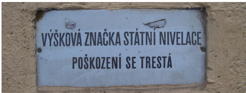
Obr. č. 12 Ukázka plechové tabulky s nápisem o poškození státní výškové značky [4]
