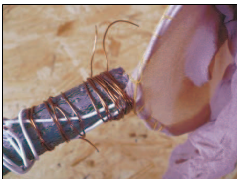
Detail upevnění planktonky na násadu pomocí měděného drátu
