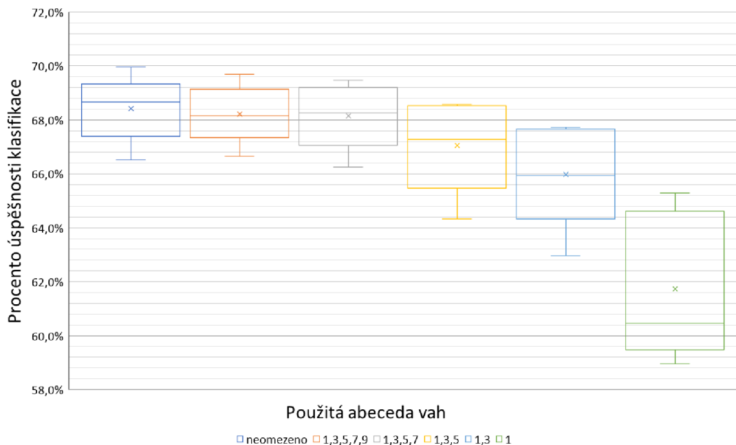
Obrázek 7.10: Úspěšnost klasifikace sítě CNN na úloze CIFAR-10 za použití násobení bez násobiček a typu FX < 8, 8 >
