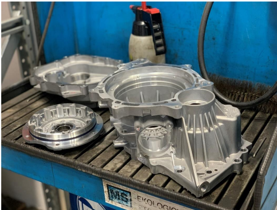
Obr. 22 Čištění dílů převodovky před dalším postupem
