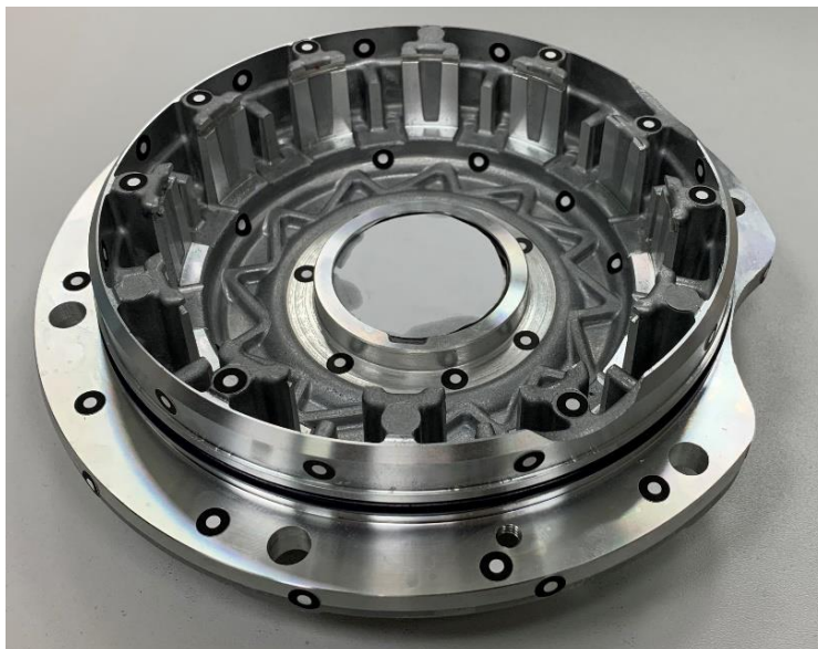
Obr. 23 Víko převodové skříně s referenčními body
