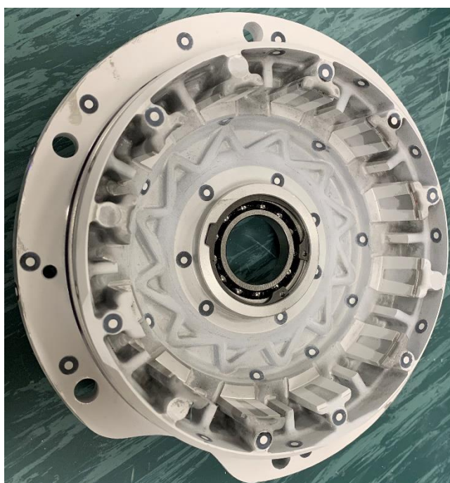
Obr. 24 Víko převodové skříně s křídlovým povlakem
