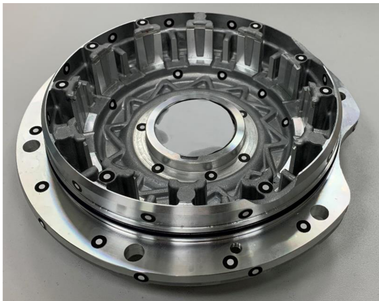
Obr. 23 Viko převodové skříně s referenčními body
