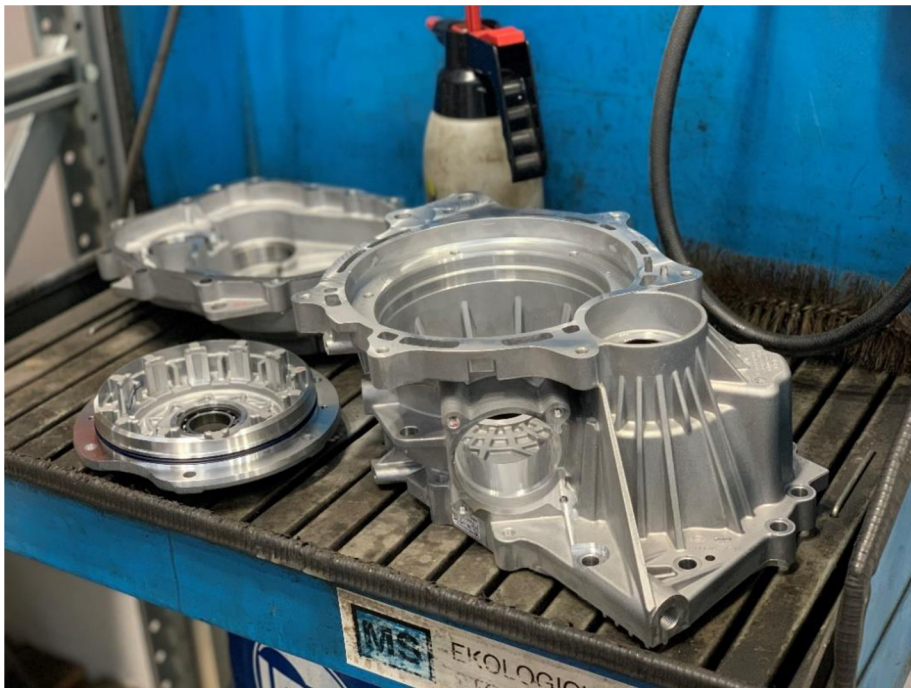
Obr. 22 Čištění dílů převodovky před dalším postupem
