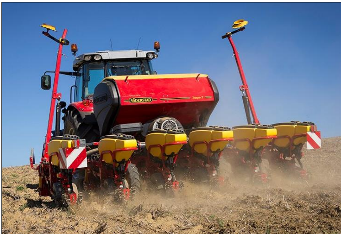
Obr. 7 Secí stroj Vaderstad Tempo R 4-6 [43]
