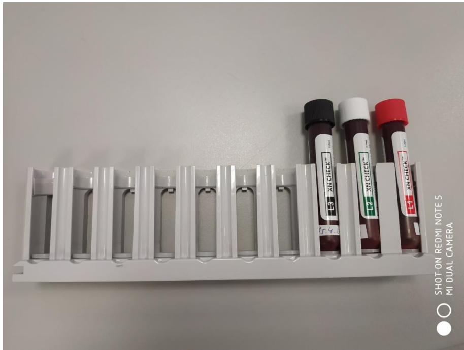
Obr. 17: Rack se zkumavkami pro kalibraci a kontrolu správných funkcí analyzátoru Sysmex XN 1000
