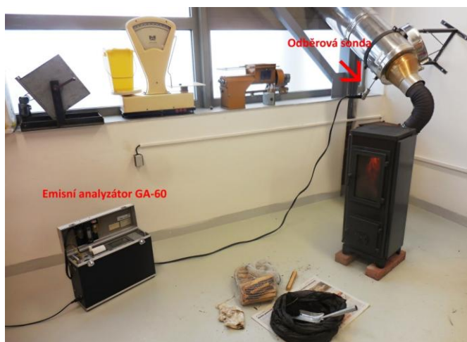
Obr. č. 14 - Měření tepelně-emisní analýzy kompostu farmář s palivovým dřevem v poměru 1:1
