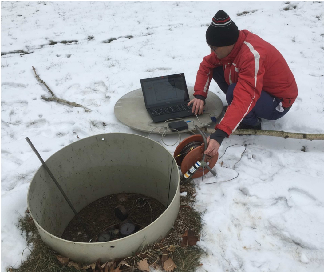
Obr. 64: Měření u zhlaví geotermálního vrtu sloužícího jako zdroj pro nízkoenergetický dům.
