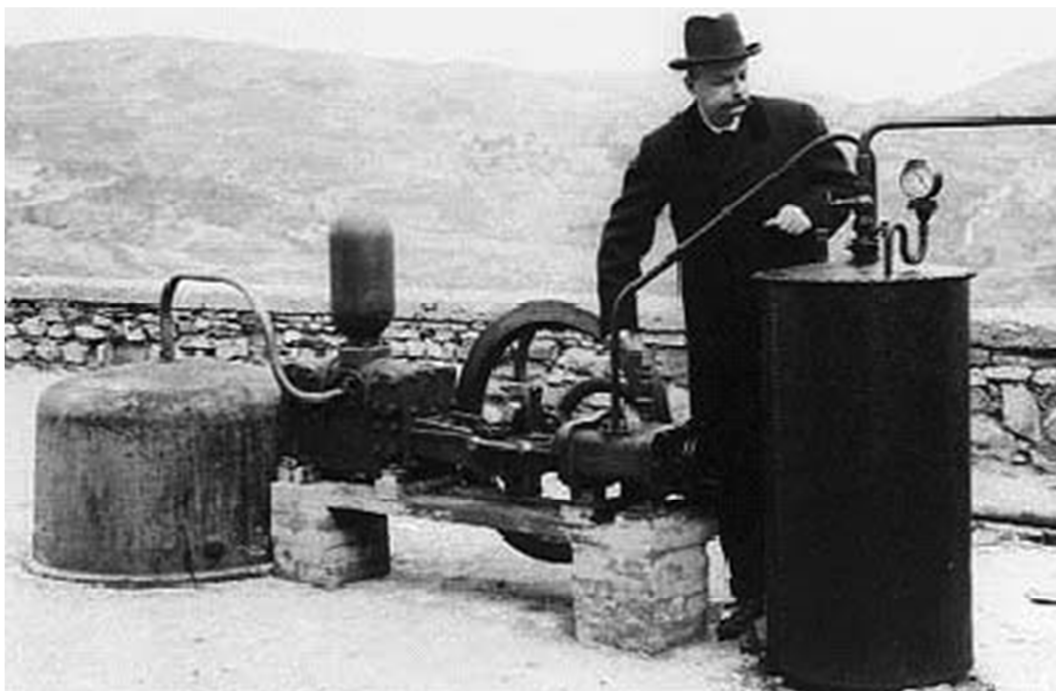
Obr. 2: Larderello, Itálie, 1904: Část technologie geotermálního elektrického generátoru, zřejmě pouze pro demonstrační účely. [5], [6]
