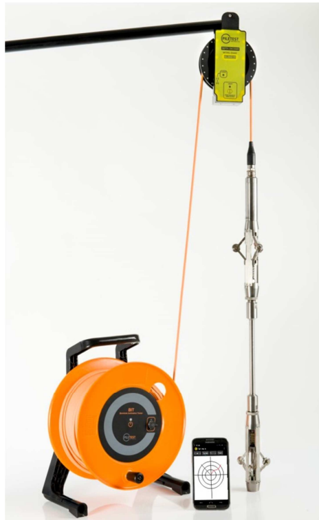
Obr. 22: Speciální inklinometr firmy Piletest BIT – sonda s vodícími vozíky, naviják a kladka s bluetooth enkodérem [31] .
