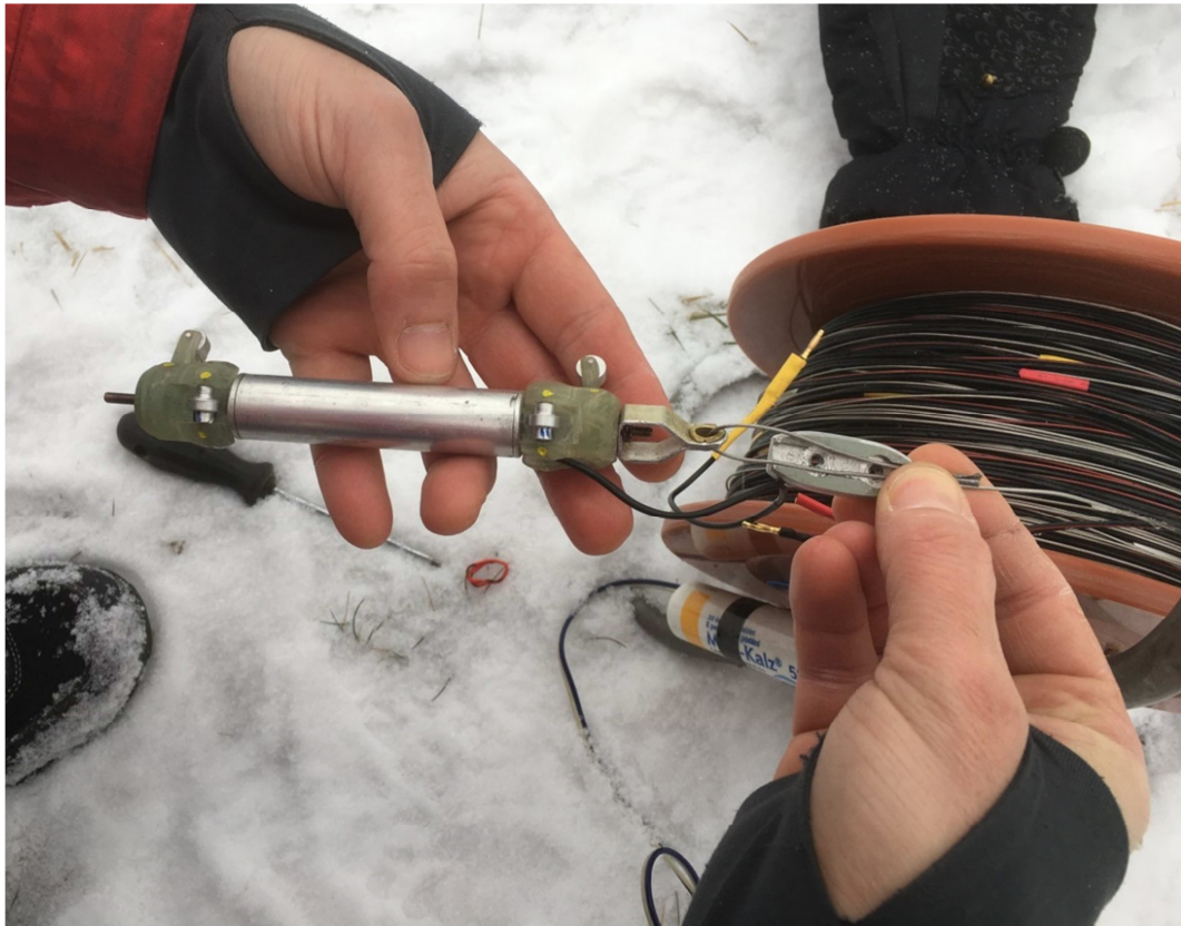
Obr. 63: „Druhá verze“ sondy připravená ke vložení do potrubí výměníku, v pozadí naviják s kabelem.
