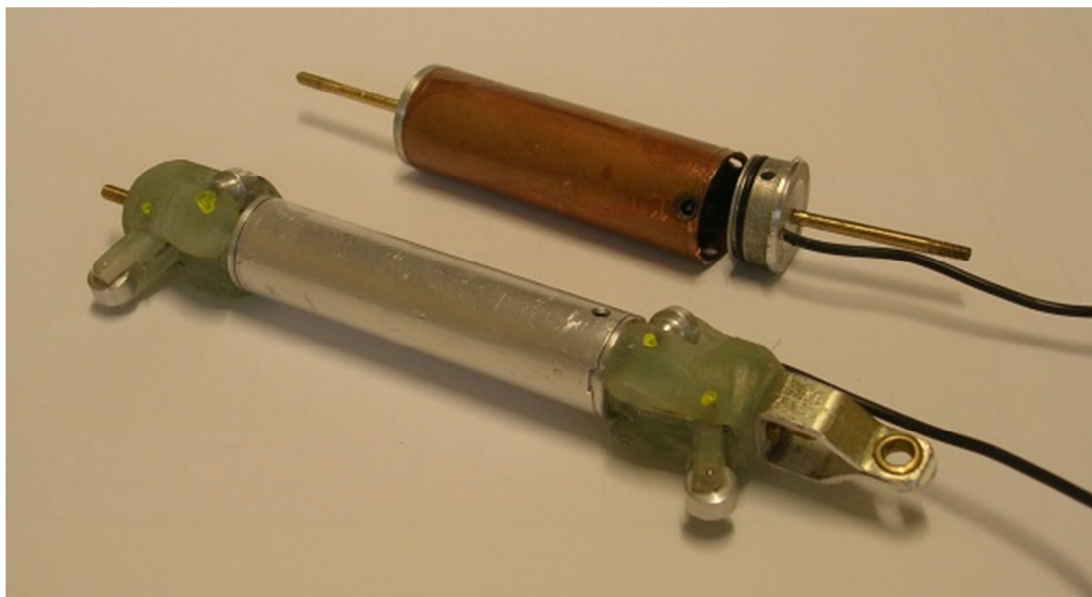
Obr. 58: Sestavená menší „druhá verze“ sondy, předchozí větší verze bez vodičích vozíků v pozadí.
