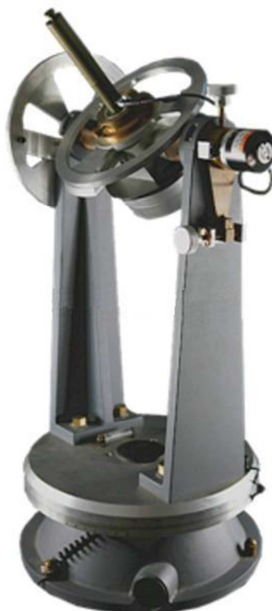
Obr. 50: Závěs automatického kalibračního přístroje pro kalibraci inklinometrů (výrobce Beijing Hekang, [46]).
