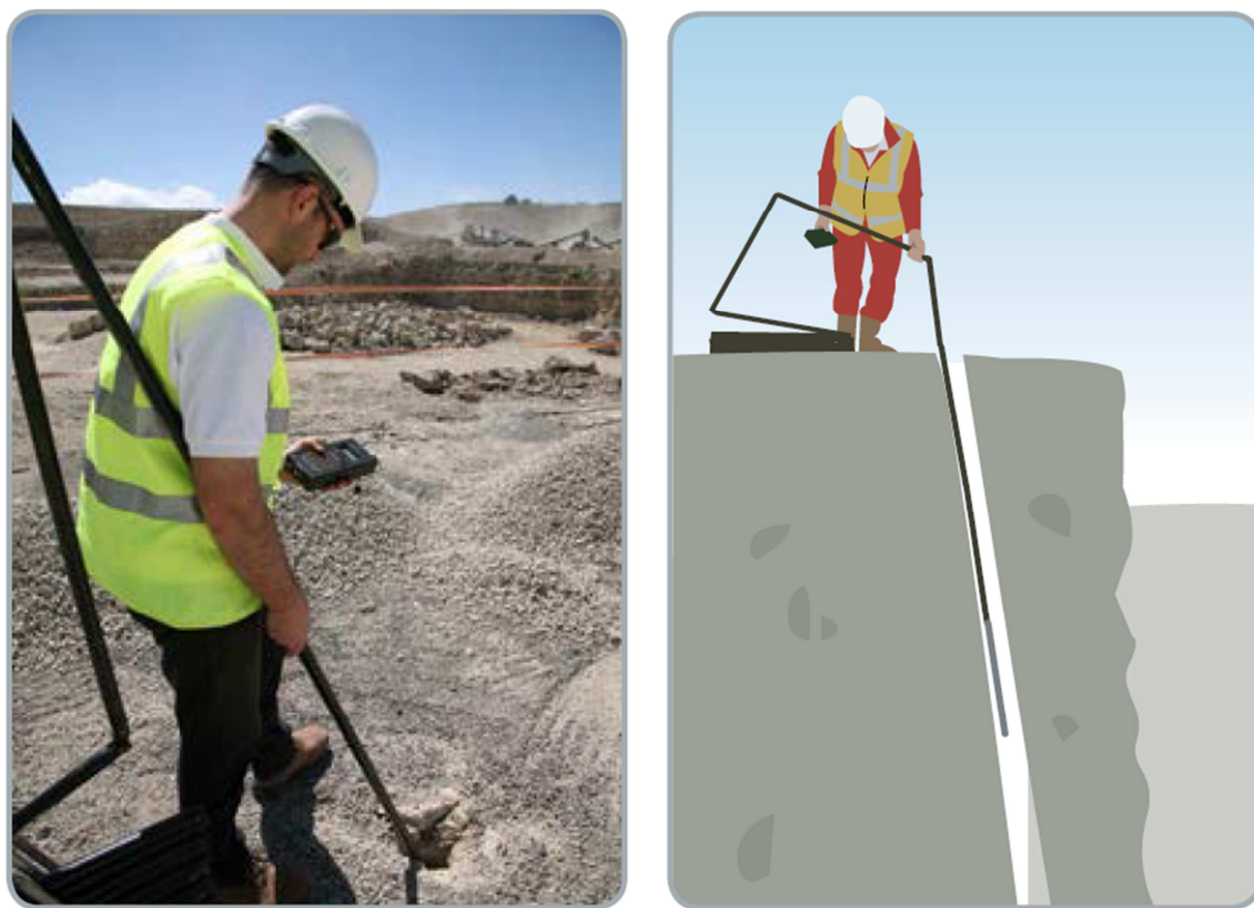
Obr. 19: Rodded Boretrak - speciální inklinometr firmy MDL (Renisaw) pro měření průběhu vrtu [27].
