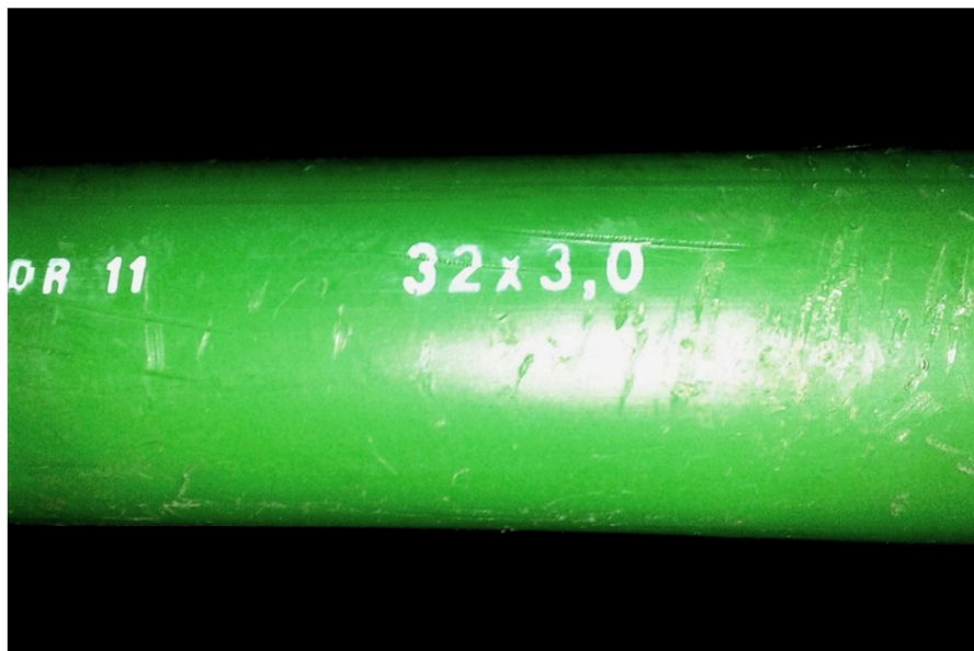
Obr. 34: Trubka tepelného výměníku – detailní foto rozměru (foto autor).
