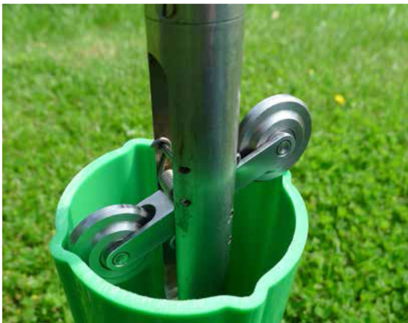
Obr. 35: Vlevo zakončení inklinometrické pažnice s částečně vloženou sondou, vpravo průřez pažnice [40].
