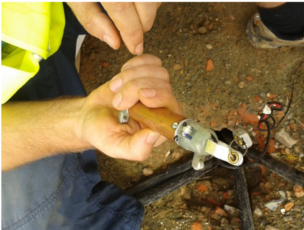
Obr. 57: Otřepy na povrchu sondy po ukončení měření.
