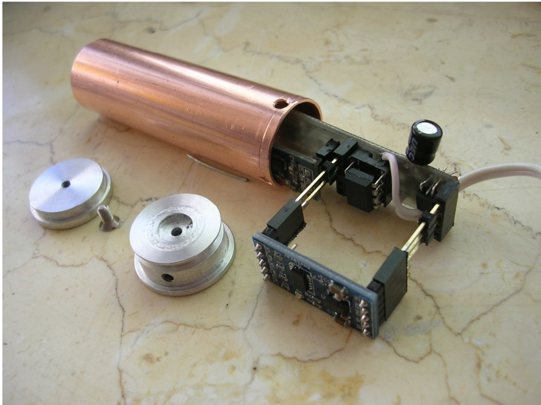
Obr. 46: První prototyp sondy – demonstrace vložení elektronické a senzorové části sondy do pouzdra (trubky).
