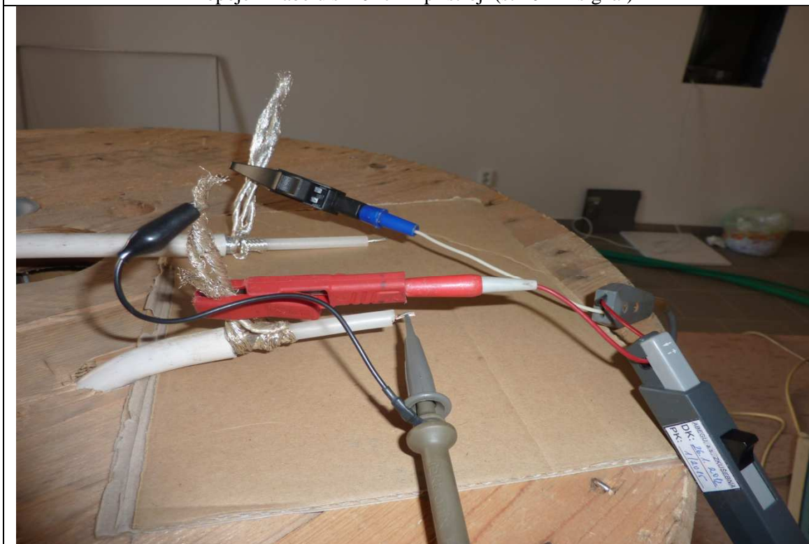
Propojení kabelu s měřicími přístroji (stínění + signál)
