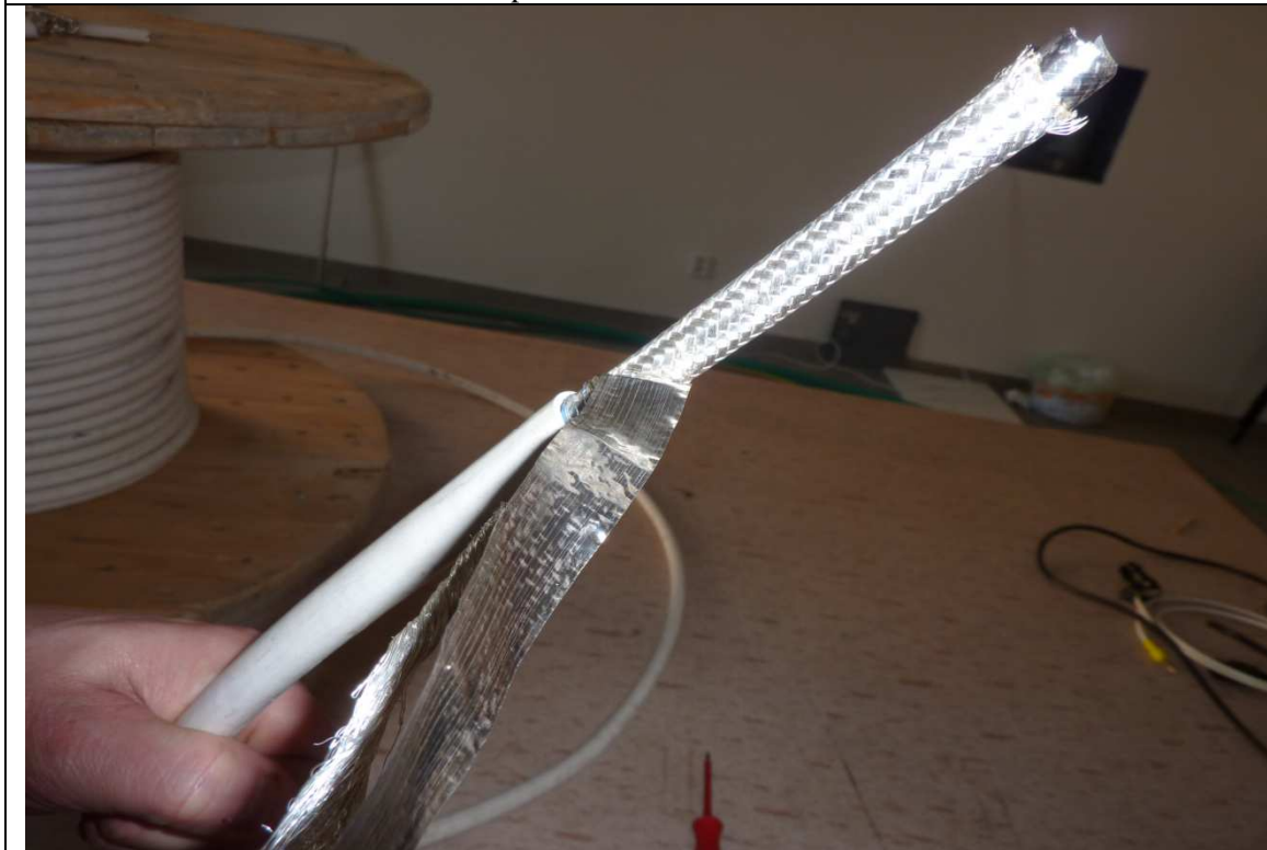
Příprava kabelu na měření
