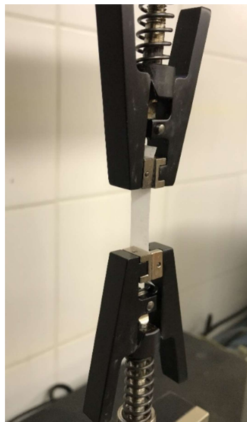
Obr.27: Testovaný vzorek upnutý do tenkých čelistí na přístroji LabTech 2.050
