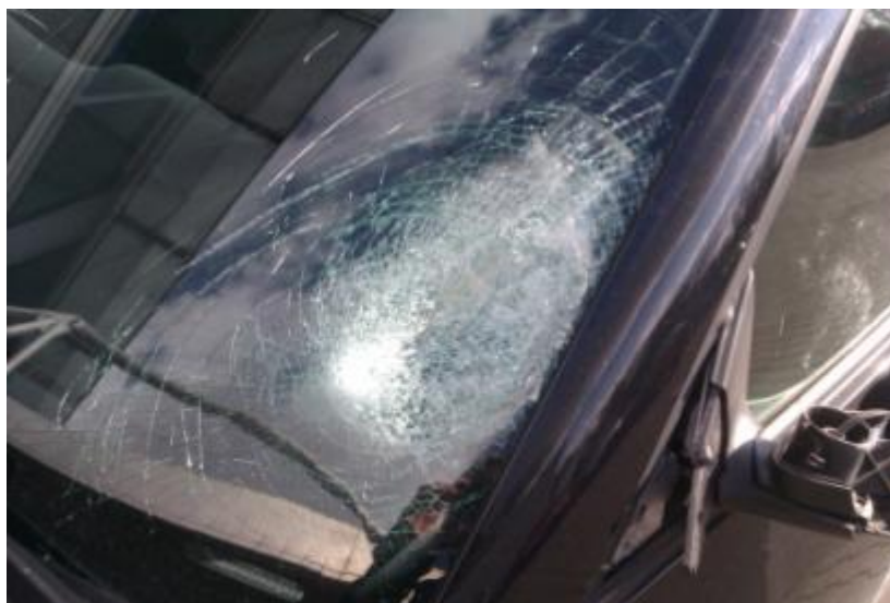
Obrázok 40: Detailný pohľad na poškodenie čelného skla a okolia
