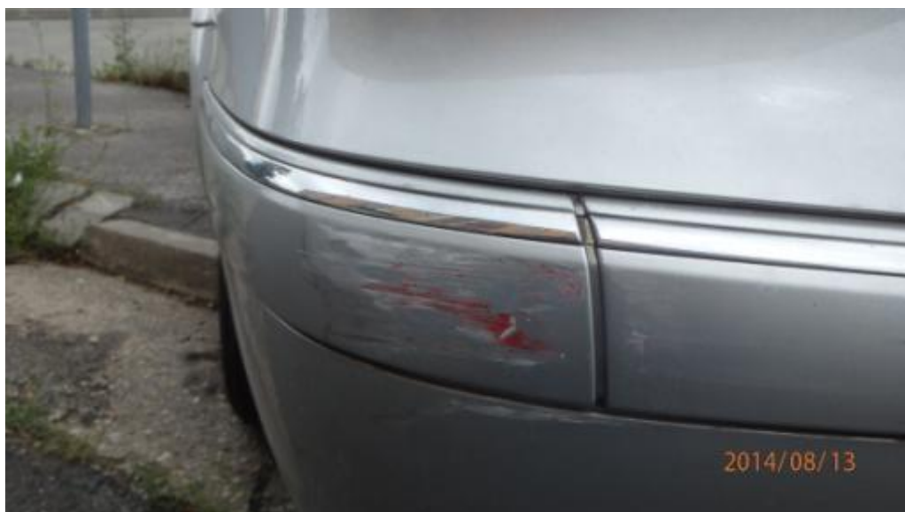
Obrázok 72: Detailný pohľad na poškodenie, viditeľná otreťá farba z vozidla vinníka
