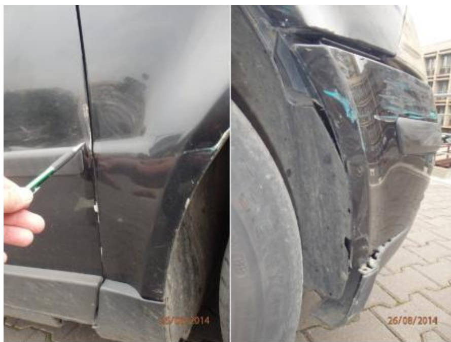
Obrázok 79: Detail poškodenia dverí nárazníku
