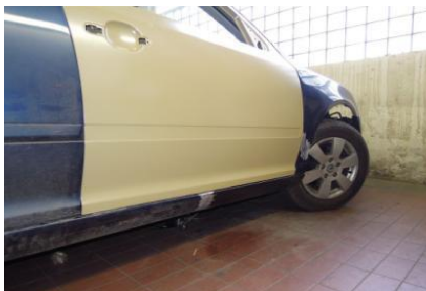
Obrázok 56: Pohľad na opravené časti pred lakovaním
