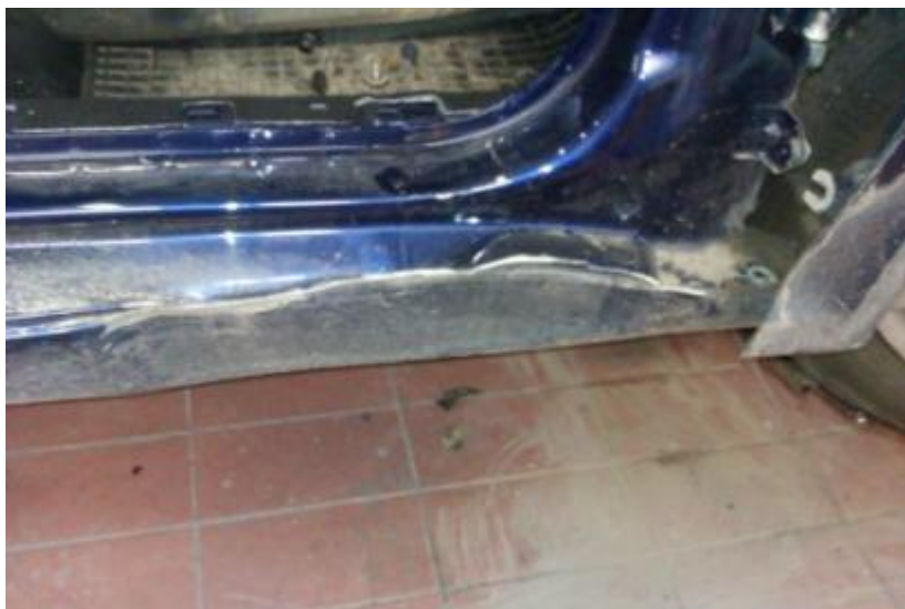
Obrázok 54: Detail poškodenia podbehu po demontáži dverí a tesniacej gumy
