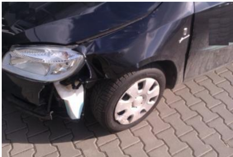
Obrázok 39: Detailný pohľad na poškodenie prednej časti kolesa
