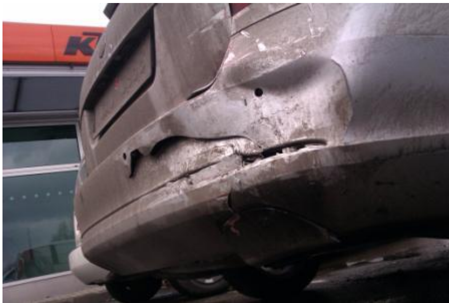
Obrázok 34: Detail poškodenia na nárazníku
