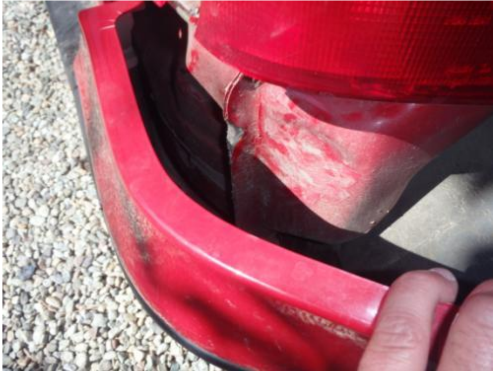
Obrázok 70: Pohľad pod poškodený nárazník
