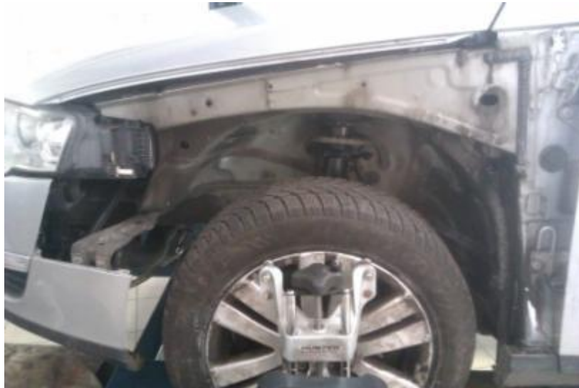
Obrázok 60: Nastavovanie geometrie po namontovaní nových dielov
