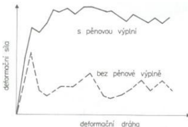
Obrázok 9: Deformačná charakteristika nosníka s penovou výplňou a bez nej [1]
