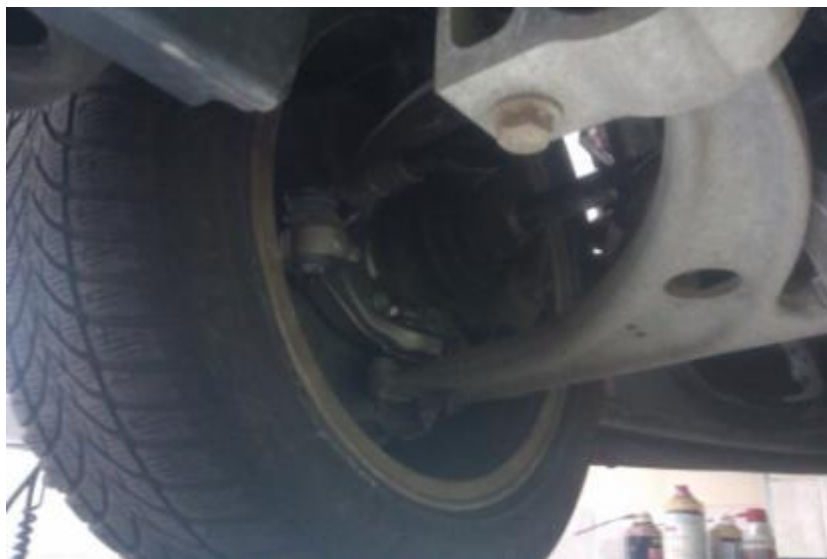
Obrázok 60: Nastavovanie geometrie po namontovaní nových dielov
