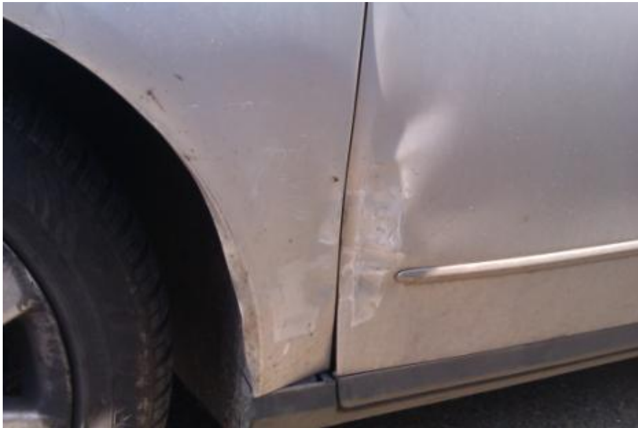
Obrázok 44: Pohľad na poškodenia v okolí kolesa
