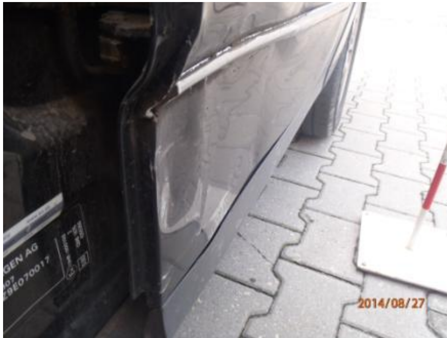
Obrázok 75: Pohľad na poškodenie zadných dverí
