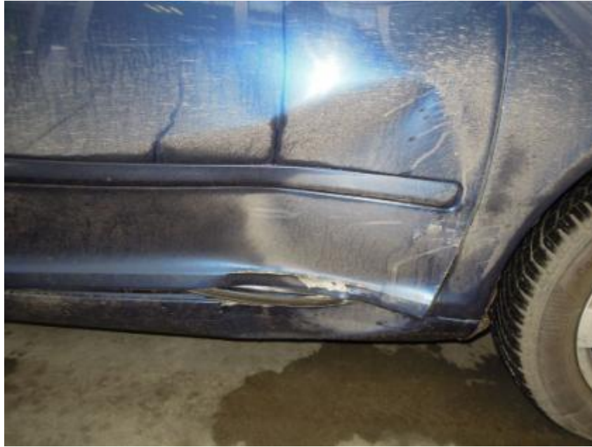
Obrázok 36: Detailný pohľad na poškodené časti
