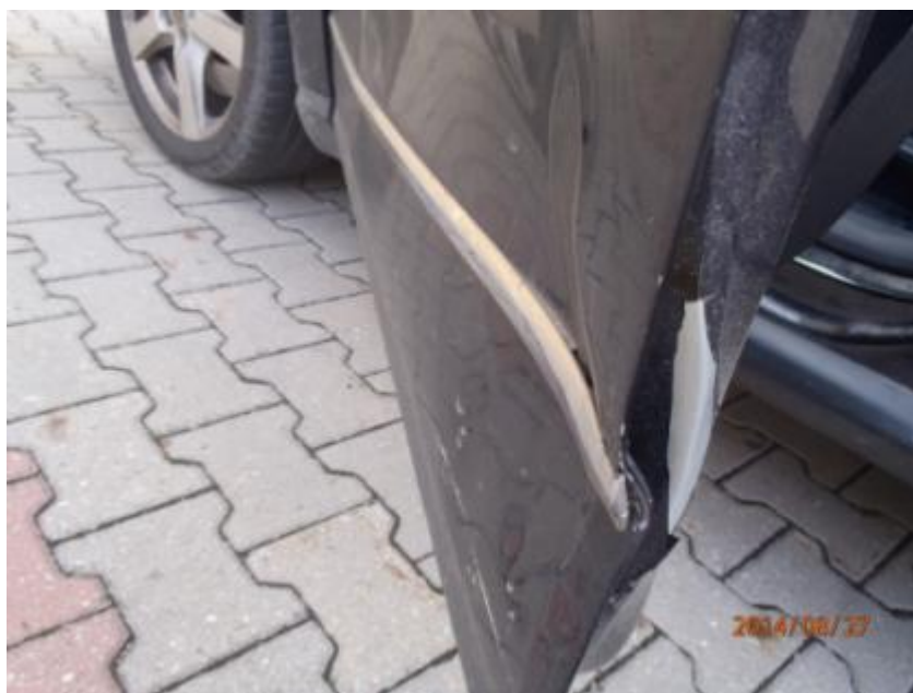
Obrázok 74: Detail poškodenia predných dverí
