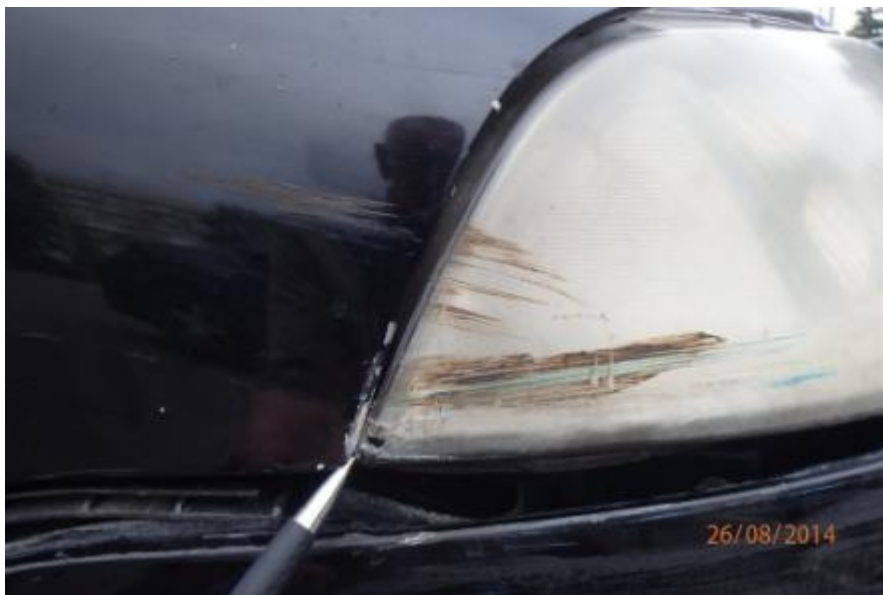
Obrázok 77: Detail poškodenia svetla
