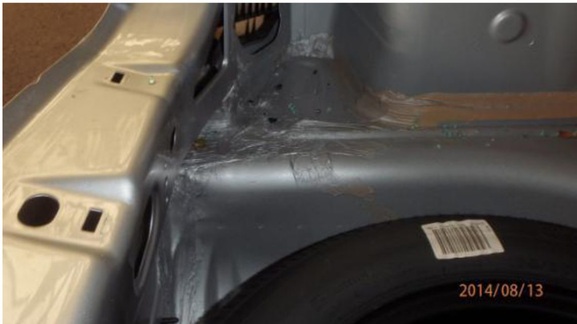
Obrázok: 66 Pohľad na opravenú deformovanú časť karosérie v kufrovom priestore
