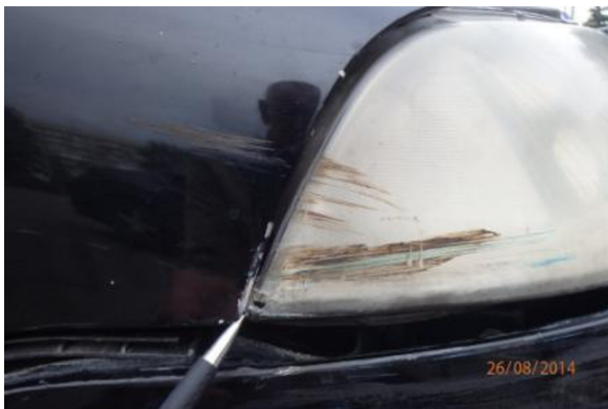
Obrázok 77: Detail poškodenia svetla
