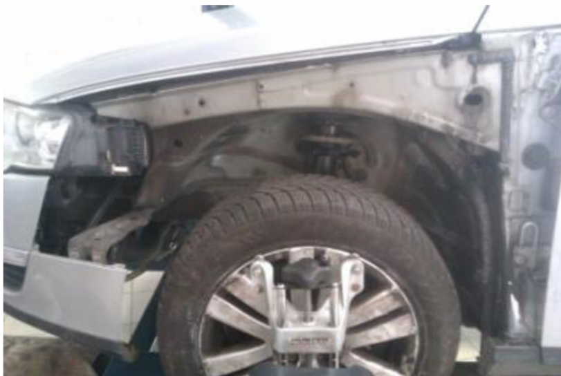
Obrázok 60: Nastavovanie geometrie po namontovaní nových dielov
