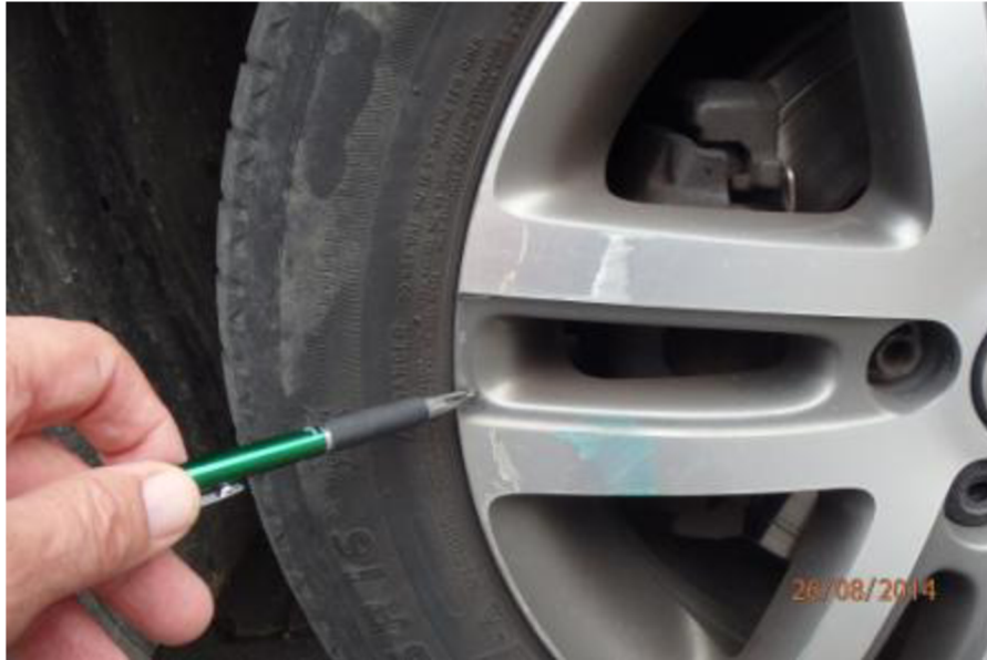
Obrázok 78: Detail poškodenia hliníkového disku
