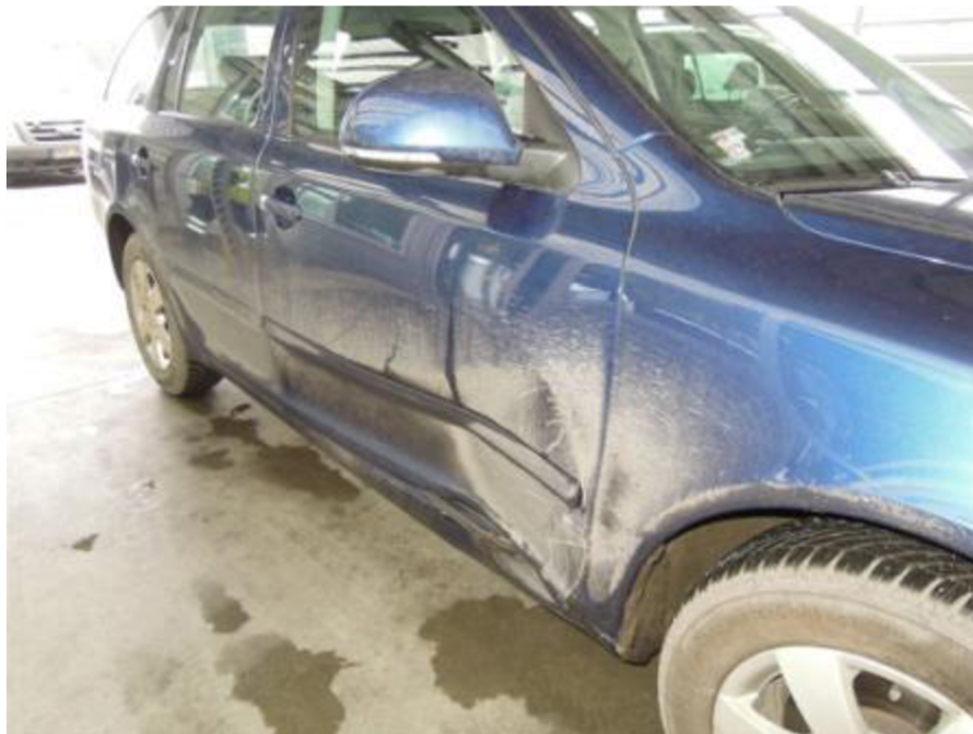
Obrázok 35: Pohľad na poškodenie vozidla Škoda Octavia
