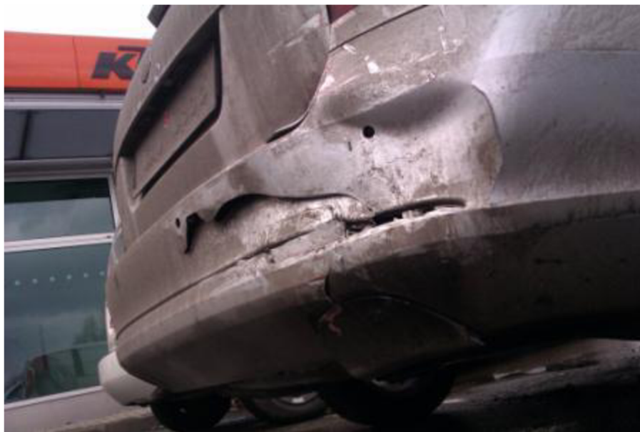
Obrázok 34: Detail poškodenia na nárazníku
