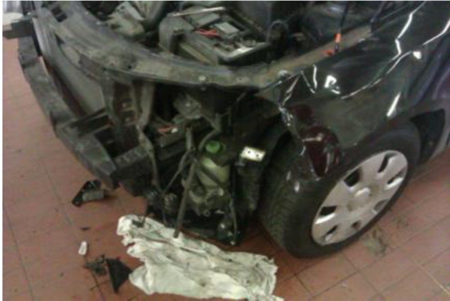
Obrázok 57: Pohľad na deformovaný držiak blatníku a poškodenú kabeláž
