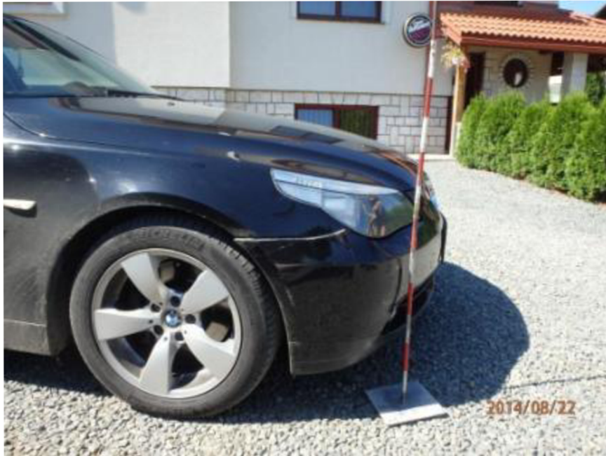
Obrázok 89: Pohľad z boku na poškodenie a vychýlený nárazník
