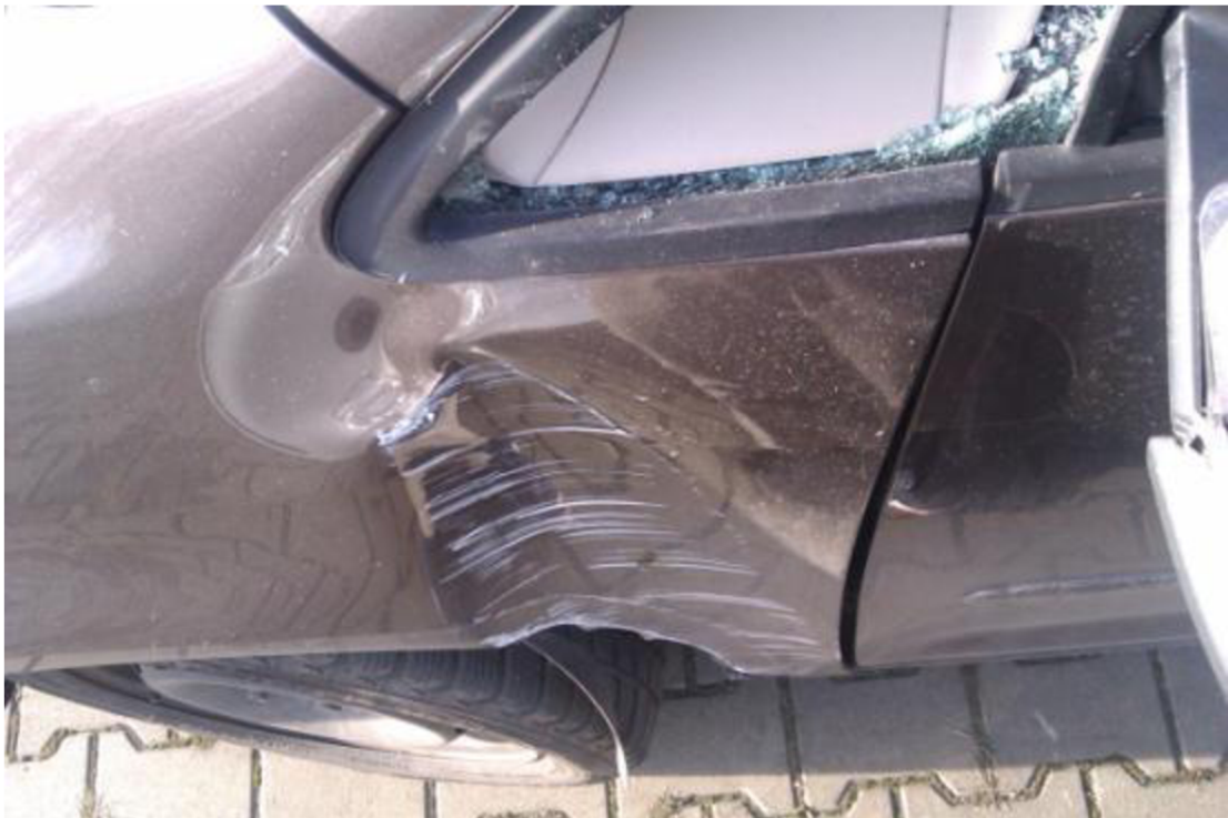
Obrázok 29: Detailný pohľad na poškodenie blatníka
