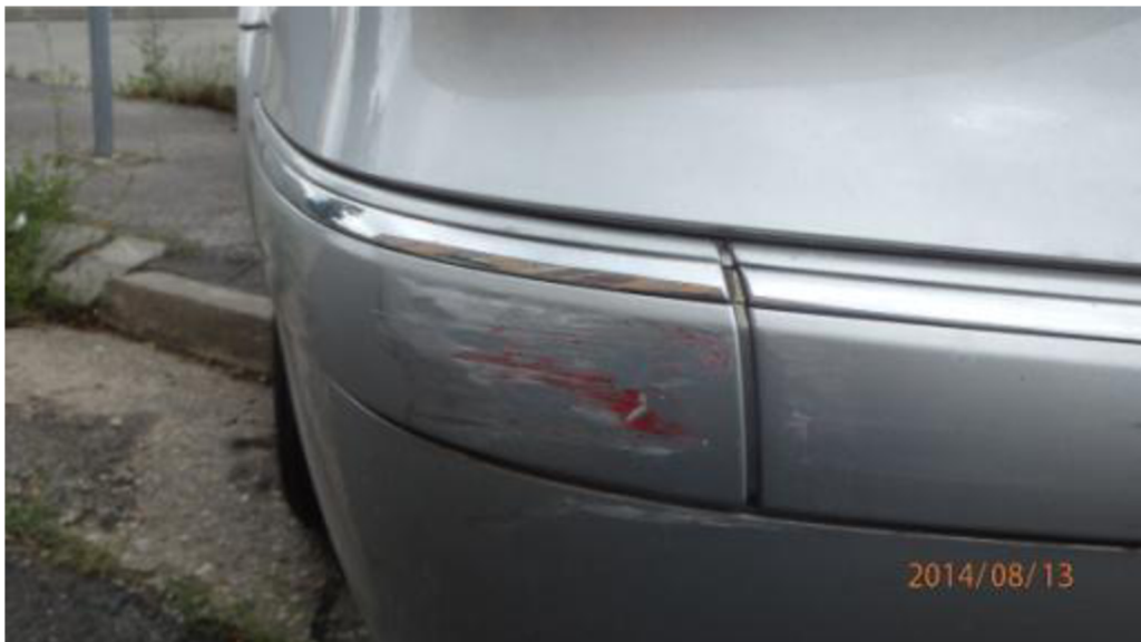
Obrázok 72: Detailný pohľad na poškodenie, viditeľná otreťá farba z vozidla vinníka
