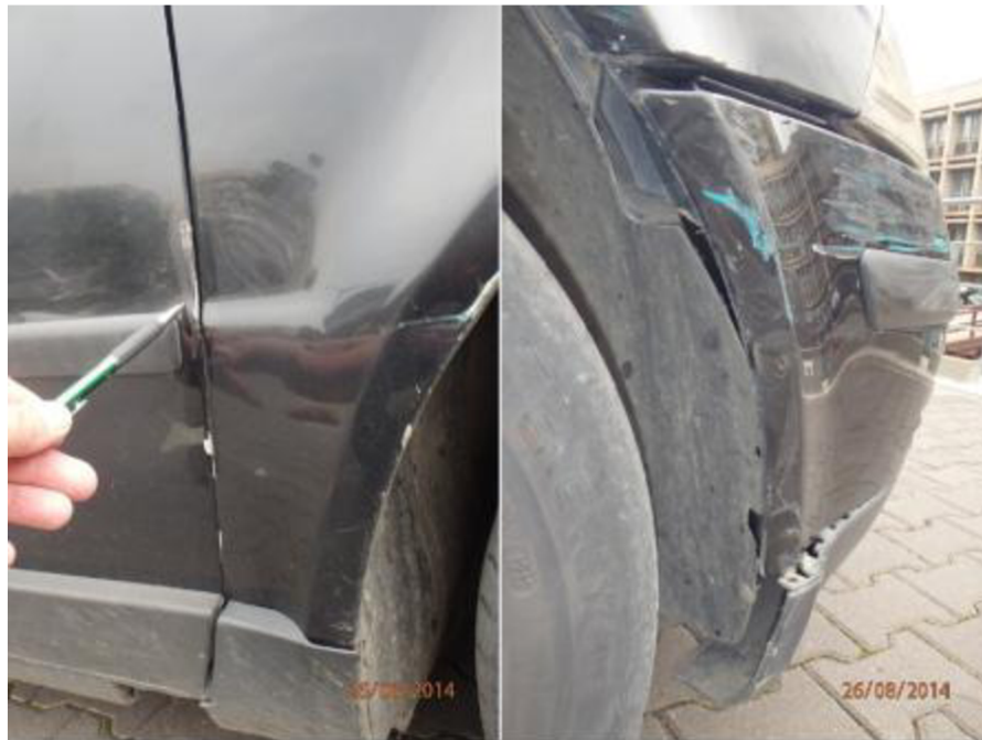
Obrázok 79: Detail poškodenia dverí nárazníku
