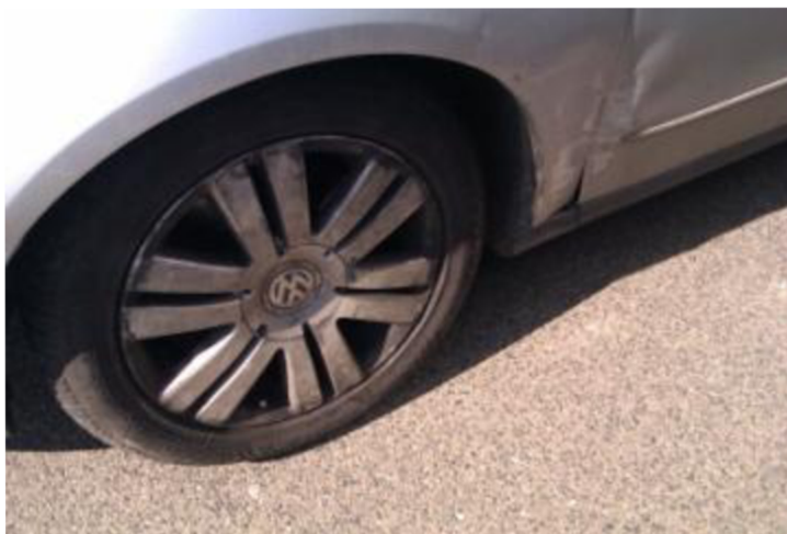
Obrázok 42: Detailný pohľad na poškodenie ľavého predného kolesa
