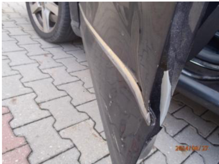
Obrázok 74: Detail poškodenia predných dverí
