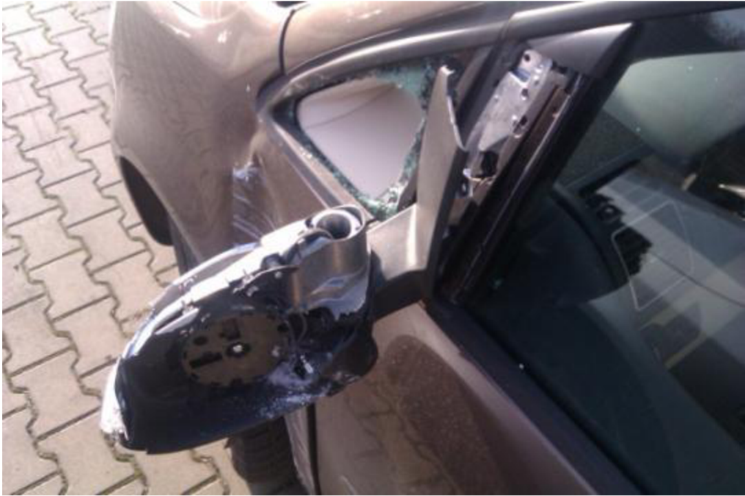
Obrázok 28: Detailný pohľad na poškodenie spätného zrkadla
