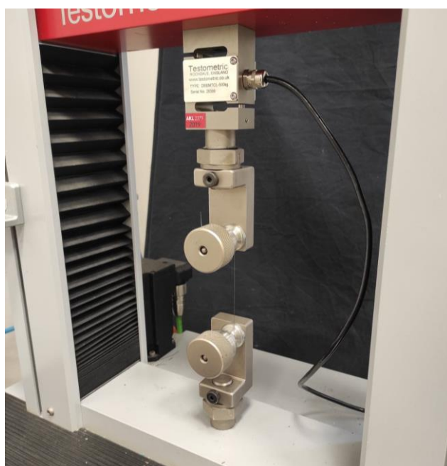
Obrázek 12 - Upnutí šňůry do čelistí přístroje Testometric M350-5CT
