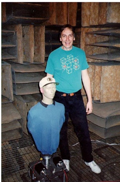
Obrázek 9: Výzkumník Bill Gardner s modelem KEMAR v bezdozvukové komoře MIT
