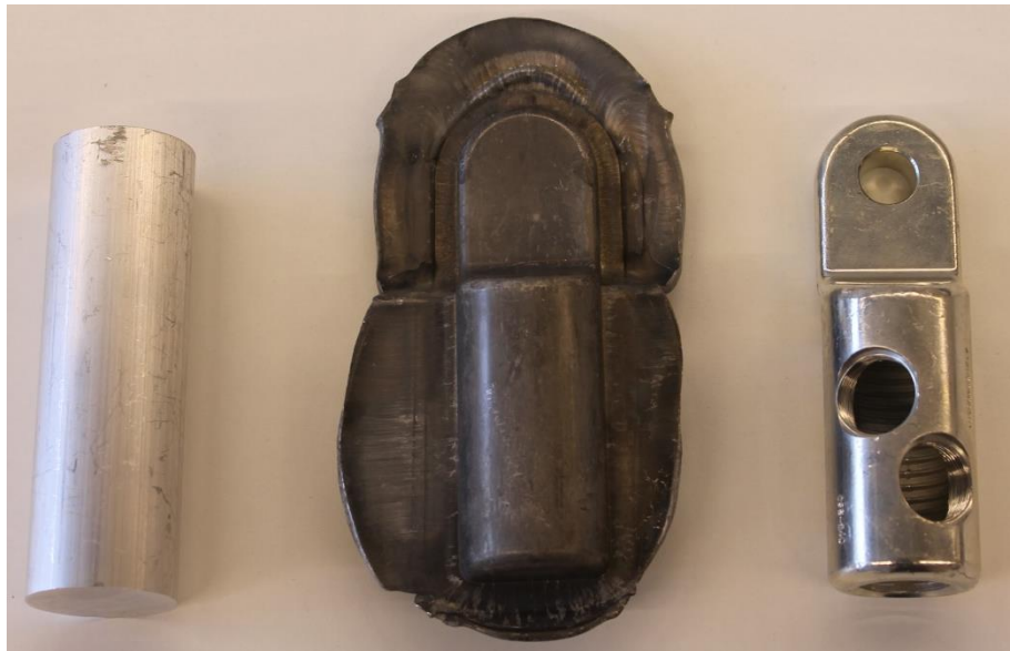
Obr. 23 Polotovar výkovku, výkovek a finální výrobek kabelové spojky
