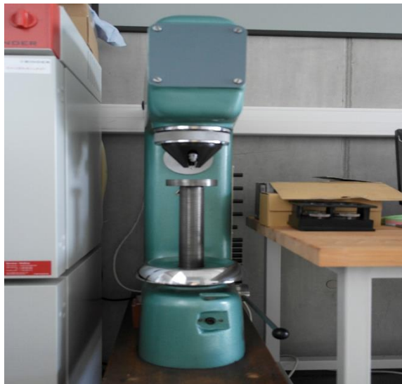
Obr. 6 Brinellův tvrdoměr v laboratoři KSP Technické Univerzity v Liberci.
