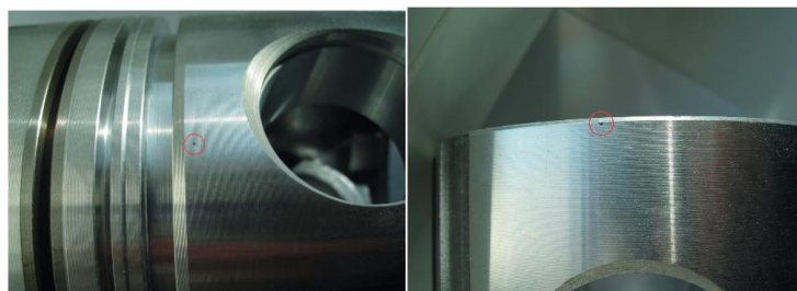
Obr. 23 Povrchové vady odhalené vizuální kontrolou. [25]
