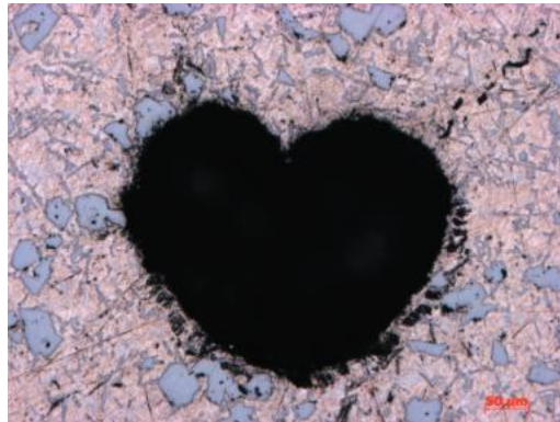
Obr. 26 Vodíkový pór ve struktuře pístu AlSi25CuNiMg. [26]
