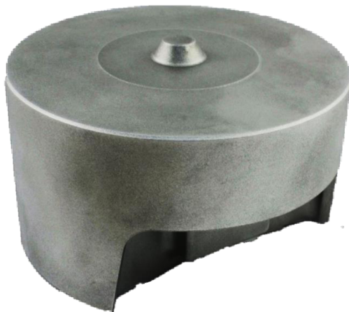
Obr. 19 Ukázka výkovku pístu ze slitiny Al. [15]
