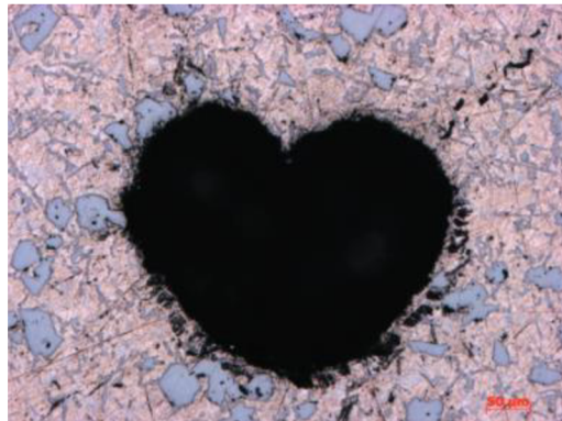
Obr. 26 Vodíkový pór ve struktuře pístu AlSi25CuNiMg. [26]
