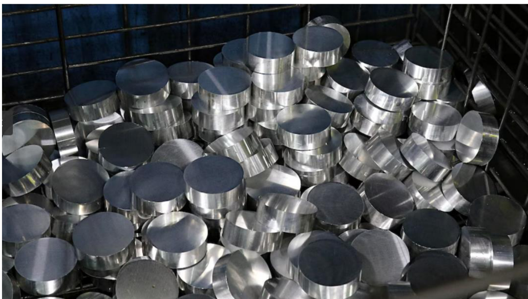
Obr. 21 Polotovary pro kování pístů. [17]
