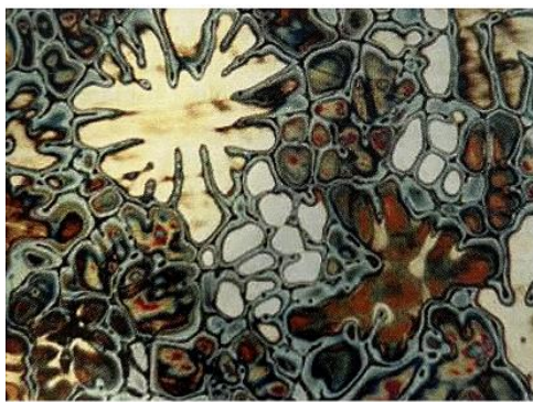
Struktura slitiny AlCu4MgMn po krystalizaci před homogenizací
