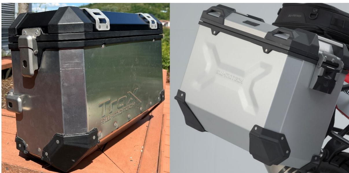
Obr. 17 Nýtovaný a svařovaný kufr [5].
