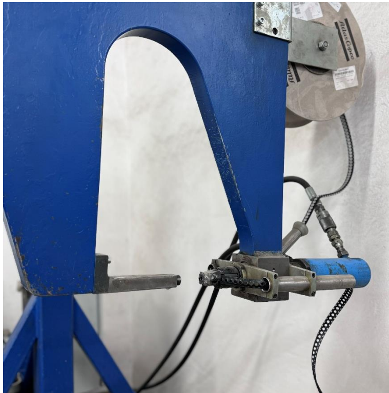
Obr. 21 Nýtovací zařízení Böllhoff.
