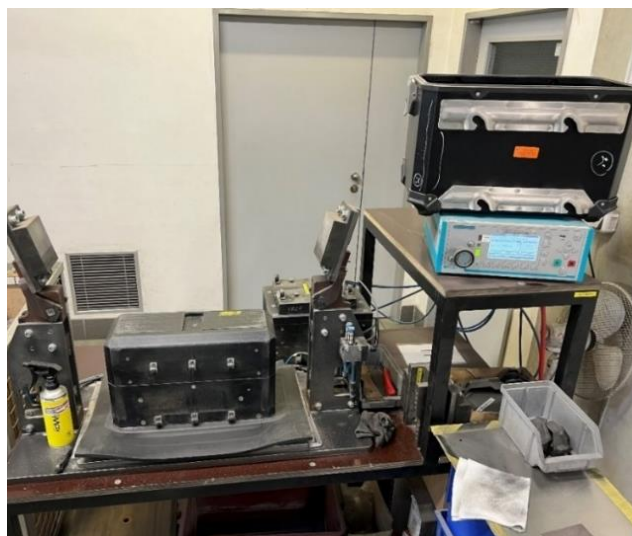
Obr. 27 Pracoviště na zkoušku těsnosti.
