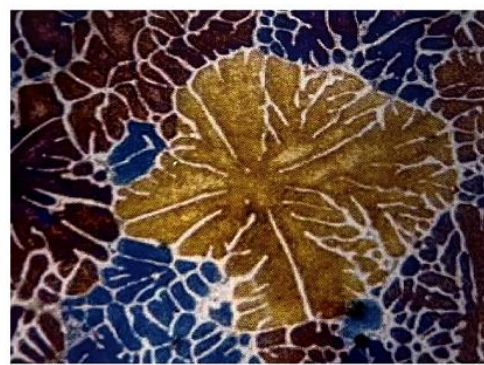
Struktura slitiny AlCu4MgMn po homogenizaci 11 hodin
