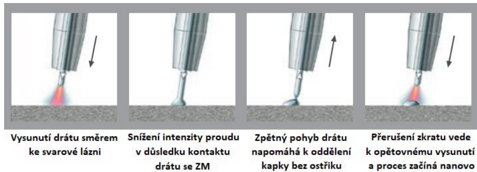
Obr. 12 Princip svařování metodou CMT [26].
