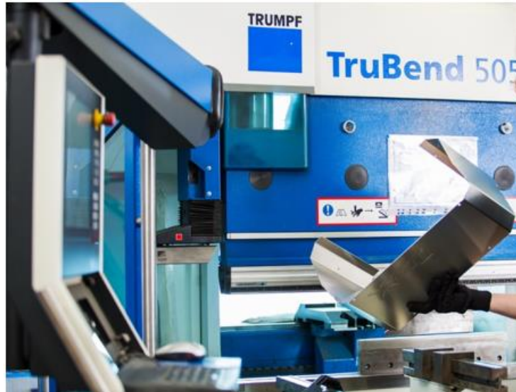
Obr. 20 Ohýbání na ohraňovacím lisu [5].
