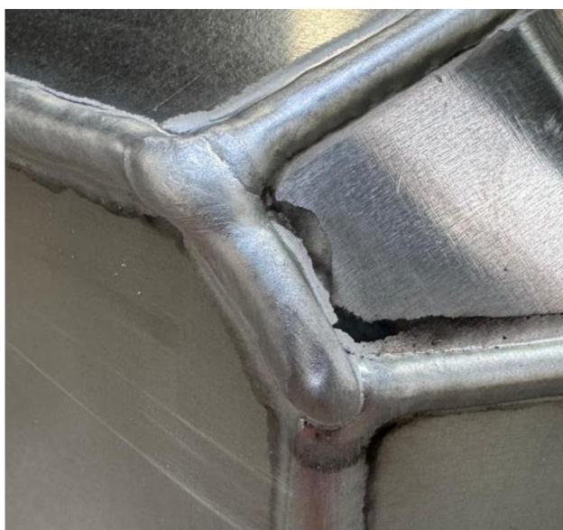
Obr. 26 Ukázka rohového svaru.
