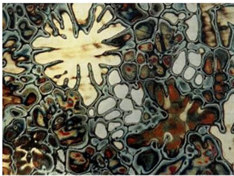
Struktura slitiny AlCu4MgMn po krystalizaci před homogenizací
