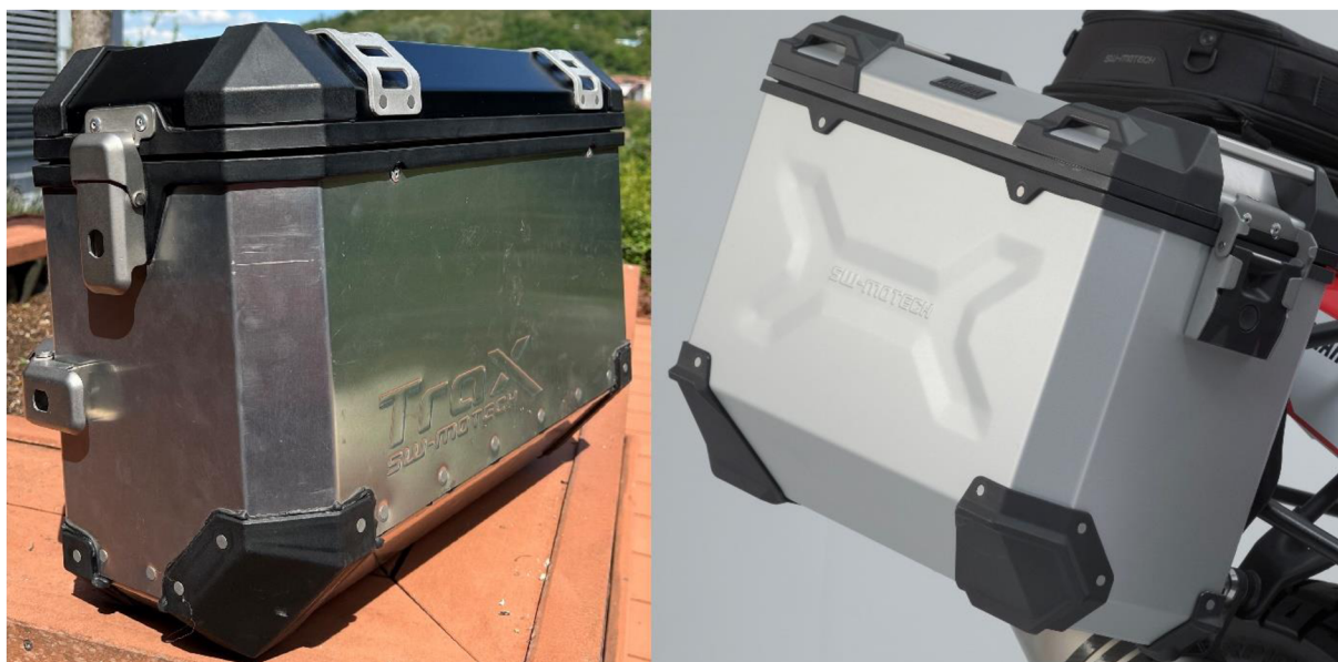
Obr. 17 Nýtovaný a svařovaný kufr [5].
