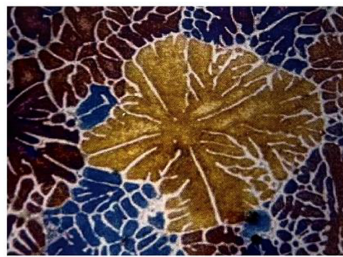
Struktura slitiny AlCu4MgMn po homogenizaci 11 hodin
