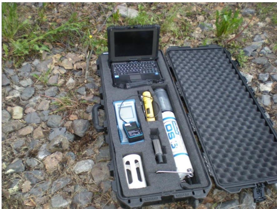
Obr. 53: Sonda Hydrolab DS 5, (Křížová, 2013)
