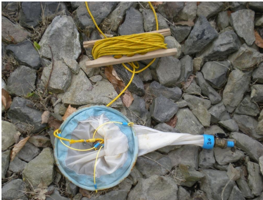
Obr. 54: Odběr fytoplanktonu -síť 20 µm, (Křížová, 2013)
