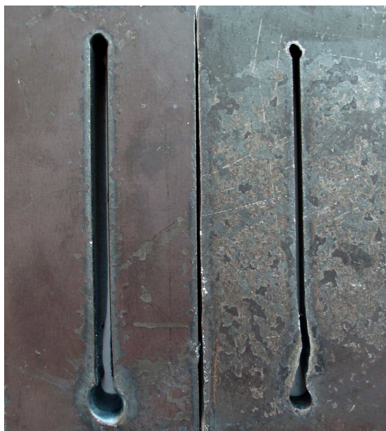
Obr. 19 Šířka řezné mezery – vlevo horní plocha, vpravo dolní plocha
