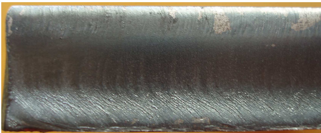
Obr. 20 Vyhlobení dělené plochy, tloušťka 15 mm
