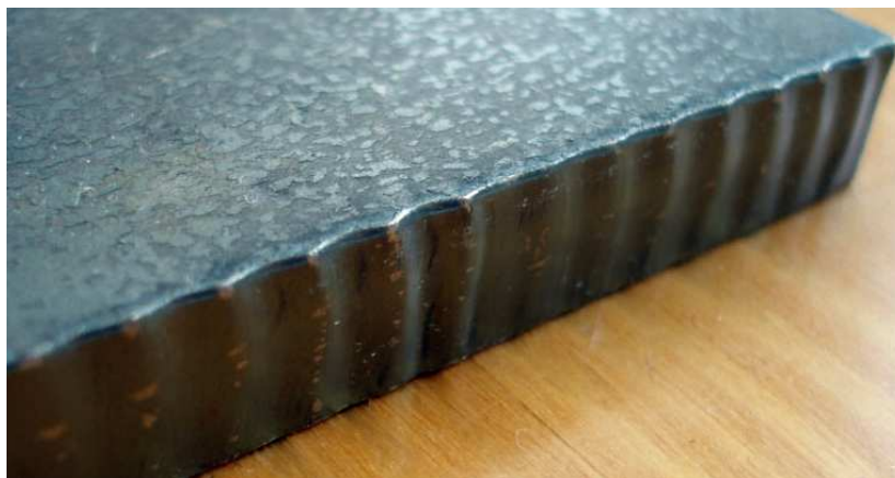
Obr. 21 Nepravidelná hloubka stopy dělení, tloušťka 12mm
