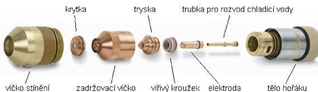
Obr. 4 Součásti hořáku [3]
