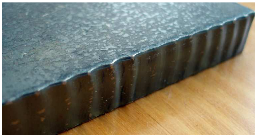
Obr. 21 Nepravidelná hloubka stopy dělení, tloušťka 12mm
